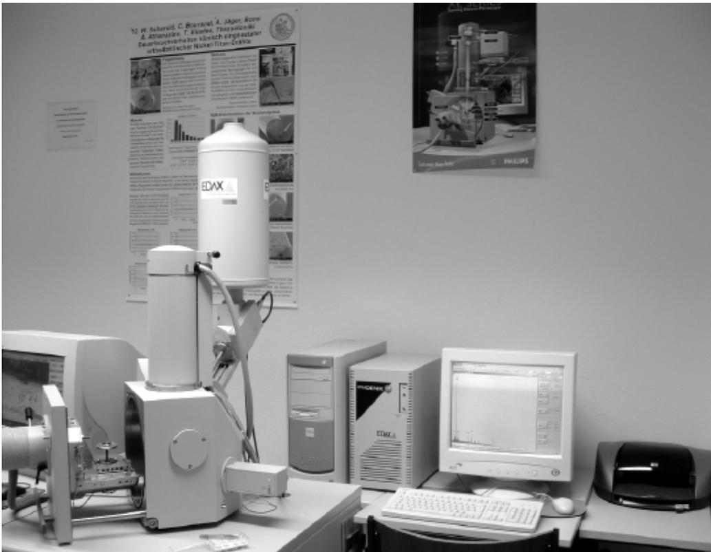
Abb. 11: Darstellung des Rasterelektronenmikroskops (XL 30, Philips) und des EDX.
