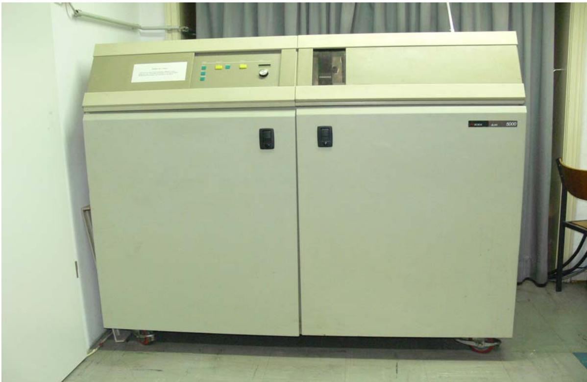
Abb. 7: Foto des verwendeten Massenspektrometers SCIEX ELAN 5000 (Perkin Elmer).
