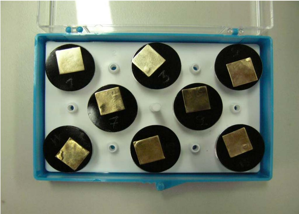
Abb. 10: Auf REM-Probenträger aufgeklebte Probenplättchen mit Nummerierung zur späteren Zuordnung.
