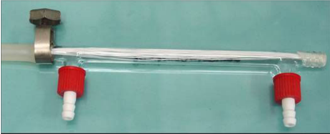
Abbildung 5.64: Lösungsmittelresistenter Hohlfaserkontaktor mit X-50 Membran von Celgard
