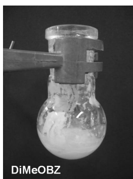
Abbildung 5.37: Im Fed-Batch Reaktor synthetisiertes (R)-3,3'-Dimethoxy-benzoin
