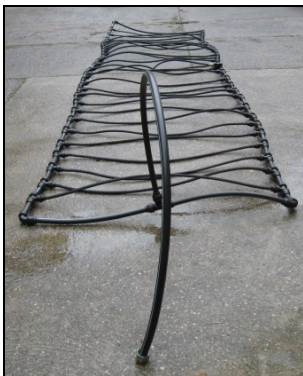
Abb. 10: Belüftungsgitter der Praxisanlage
