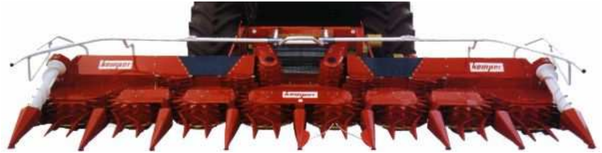
Abb. 3.1: Reihenunabhängiger Erntevorsatz für Feldhäcksler, der für die Hanfernte eingesetzt wurde
