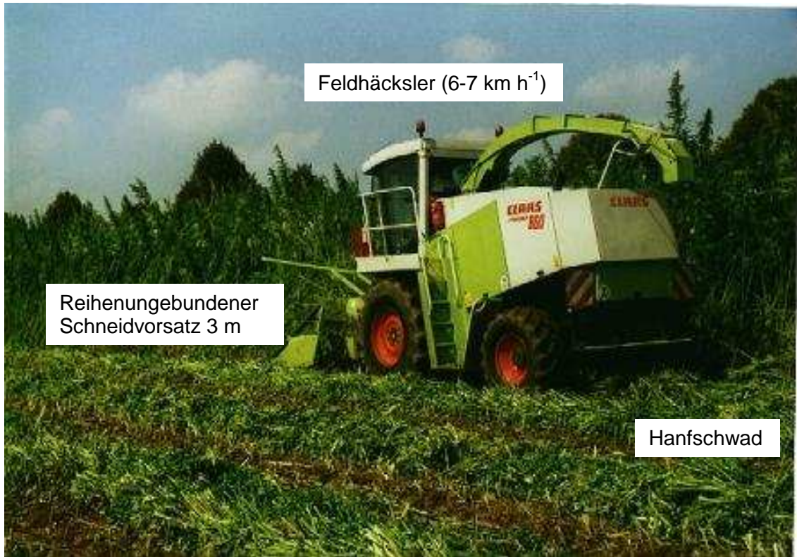
Abb.2.6: Gutstromeinkürzung bei Hanf mittels System Hemptcut
