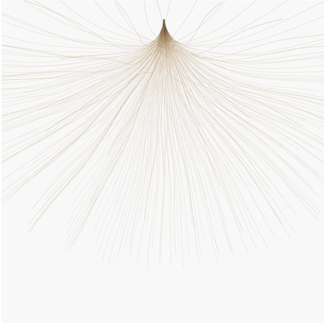
Abbildung 4.8: Das Bild zeigt die vorgekrümmte Faseranordnung bei T=25\text{ }^{\circ}\text{C} und RH=65\% (bei selber Ladung), jedoch ohne den Effekt der Gravitation.
