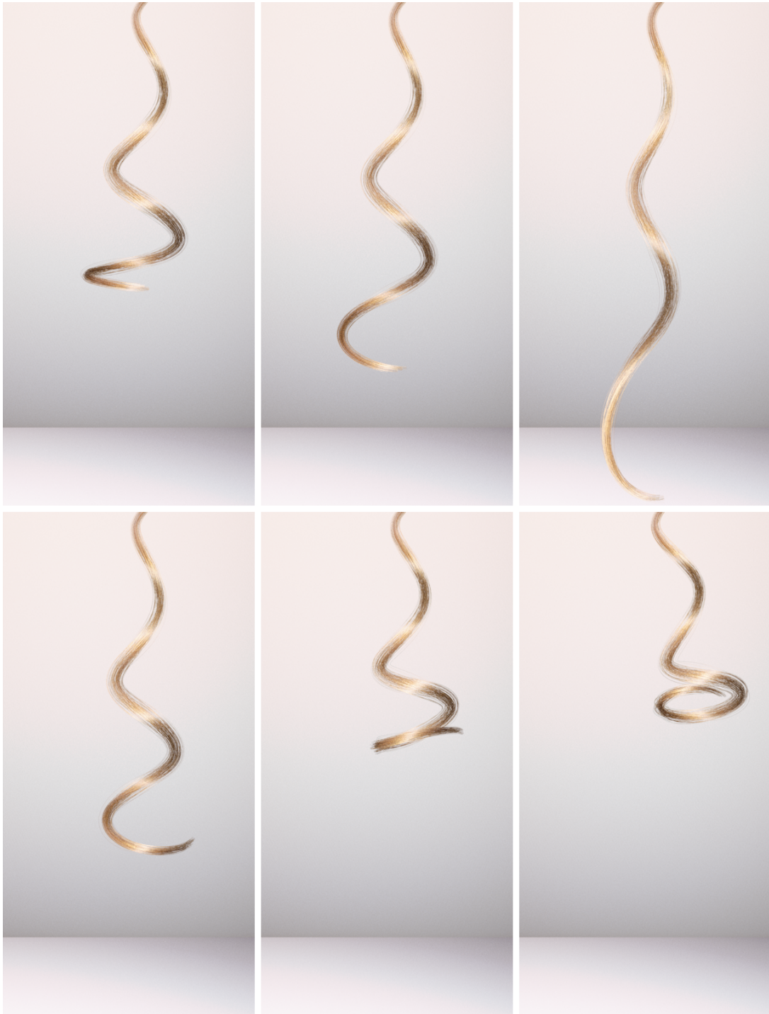
Abbildung 3.21: Eine Faseransammlung bestehend aus 180 einzelnen Fasern wird mit konstanter Rate auseinander gezogen und anschließend aus der gespannten Lage entlassen. Die untere Reihe zeigt das Zurückschnappen der Ansammlung. In dieser Phase treten große Beschleunigungen auf.
