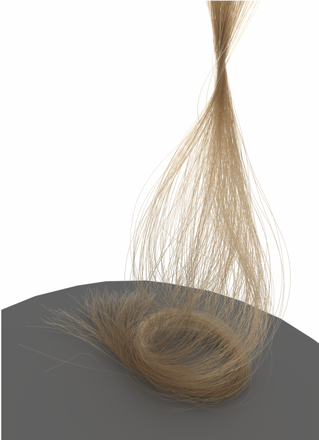
Abbildung 8.10: Dieses Bild zeigt eine Nahaufnahme der Anordnung in ihrer Endlage nach wenigen Sekunden Simulationszeit. Der Effekt der konsequenten Kollisionauflösung ist sehr gut zu sehen. Die Fasern ruhen infolge der reibungsbehafteten und teilweise inelastischen Antwortimpulse aufeinander und formen ein statisches Volumen aus.
