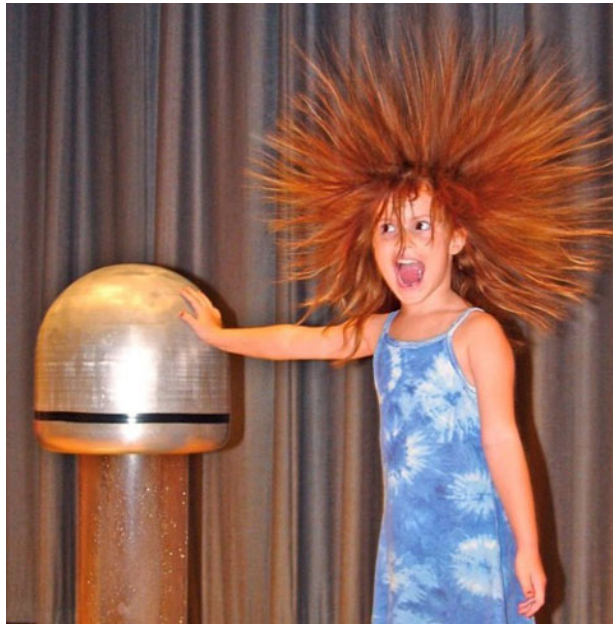
Abbildung 4.1: Berühmter Versuch: Die Testperson lädt sich an einem Van-de-Graaff-Generator elektrisch auf. Die Haare stellen sich in der Folge entlang der Feldlinien des sich ausbildenden elektrischen Feldes auf (Quelle: American Museum of Science & Energy).
