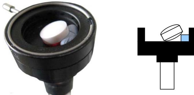
**Abb. 3.13: Seitliche Fixierung der Tablette in Blende während der Aufnahme des NIR-Spektrums [eigenes Photomaterial]**
