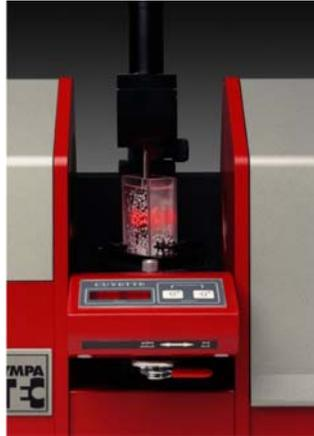
Abb. 3.8: Nassdispergiersystem CUVETTE der Firma Sympatec [31]
