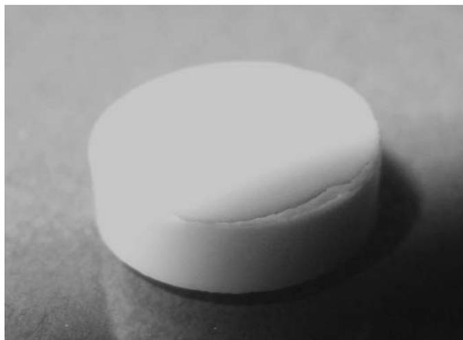
**Abb. 4.57: Photo einer deckelnden Tablettose 70 Tablette [eigenes Photomaterial]**
