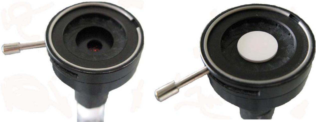
**Abb. 3.4 Blendenaufbau zur Spektrenaufnahme von Tabletten (ohne und mit Tablette) [eigenes Photomaterial]**
