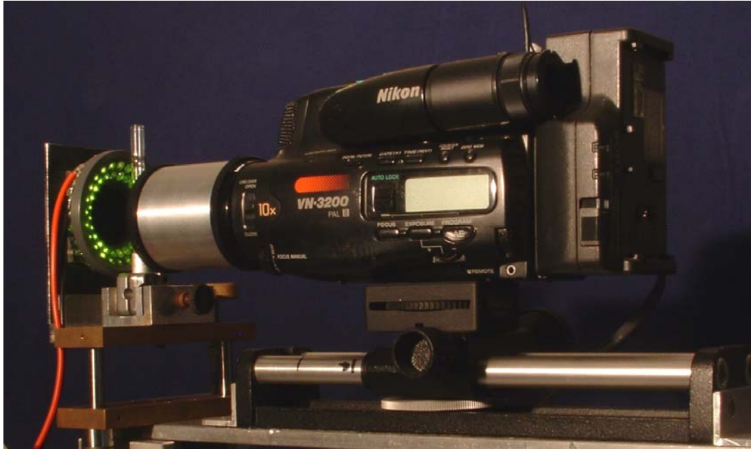
Abb. 2.12: Foto der Apparatur zur Aufnahme sedimentierender Zellen. Camcorder mit Makrolinsen ausgerichtet auf die Pasteurpipette welche durch einen Leuchtdiodenring in Dunkelfeldanordnung beleuchtet wird.
