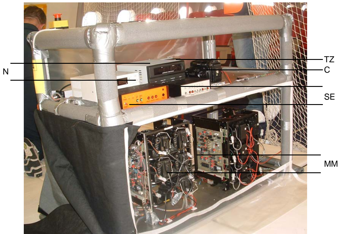
Abb. 2.11: Parabelflugapparatur integriert in das Parabelflugzeug A300 0 g. TZ: Temperatur- und Zeitanzeige, C: Camcorder, SE: Steuerungseinheiten, MM: MIKROBA-Module, N: Netzteile
