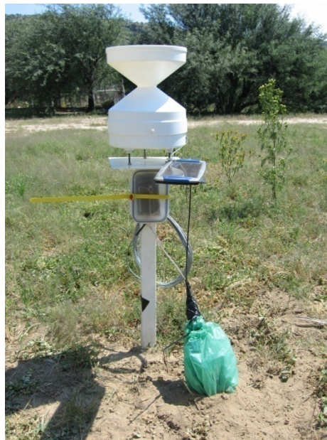
Abbildung 4-7: Niederschlagsmessstation in Brakwater mit Datalogger, Solarpanel und Kabelzufuhr zur 12 V Autobatterie. (Quelle: eigenes Foto)
