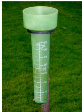
Abbildung 6-1: Einfacher Regenmesser (in Namibia vielfach auf Farmen eingesetzt). (Quelle: eigenes Foto)
