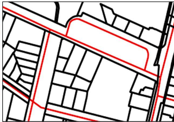
Darstellung der Straßen- und Wegeachsen im ATKIS® Basis-DLM in Kombination mit Flurstücksgrenzen
