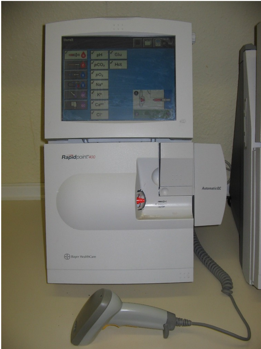
Abbildung 7: Rapidpoint 400 zur Bestimmung der Blutzuckerkonzentration mittels Blutgasanalysegerät (Aufnahme: Meike Claussen)
