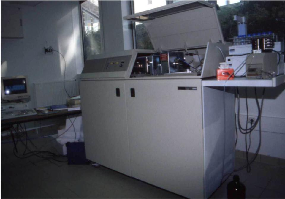
Abb. 7: Das verwendete Plasmamassenspektrometer Sciex Elan 5000 (Perkin Elmer).
