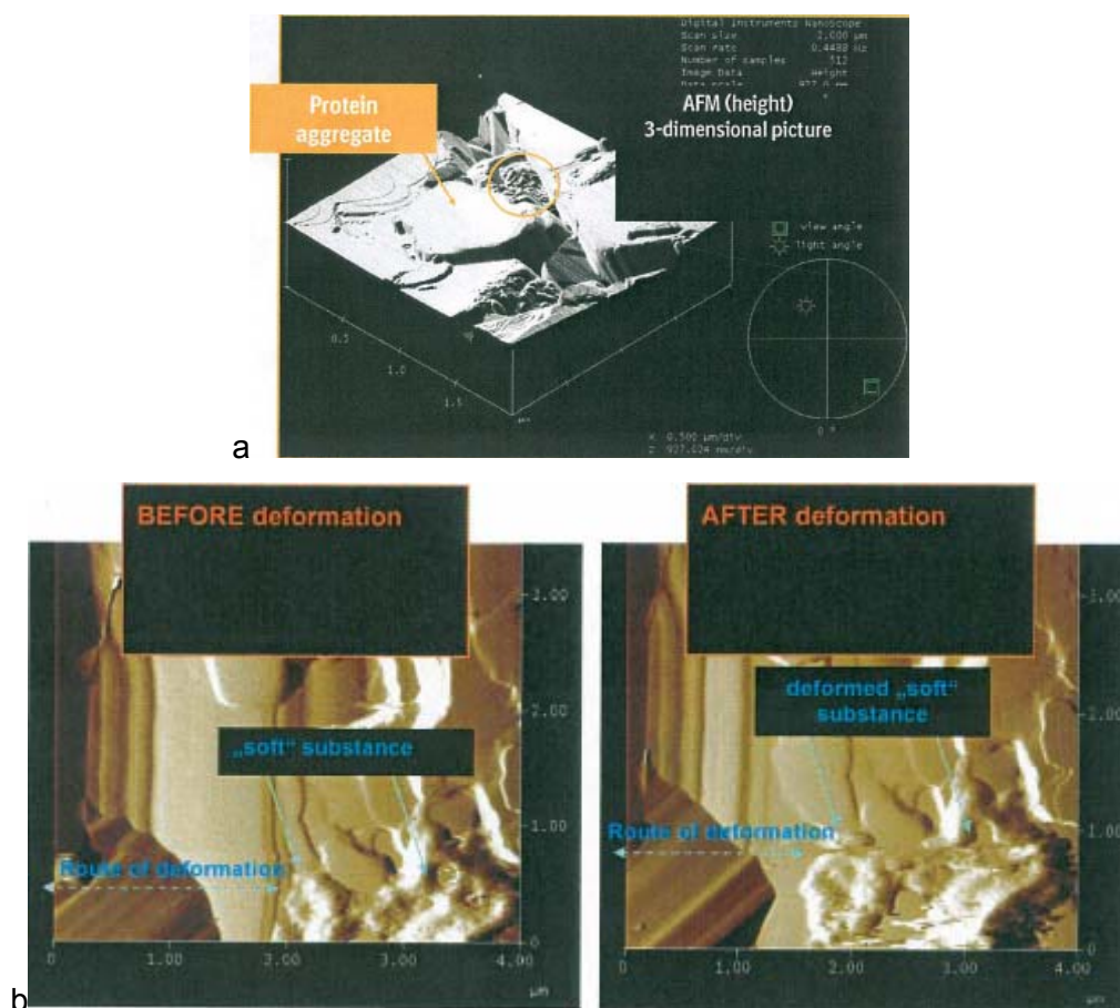
Abb. 2-D Messungen mit dem Rasterkraftmikroskop [Bechtold-Peters, 2009] a – Proteinaggregat auf der kristallinen Oberfläche, b - Protein vor und nach der Deformation mit Cantilever im Kontakt-Modus
