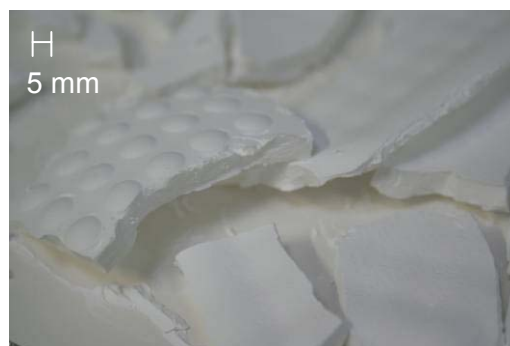
Abb. 5-LL Kompakter Filterkuchen von Albumin-Glycin Co-Kristallen nach Membranfiltration
