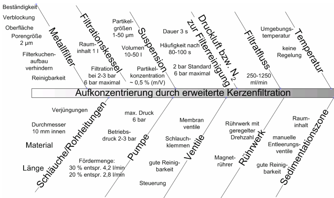
Abb. 5-WW Prozessanalyse erweiterte Kerzenfiltration (MPF)
