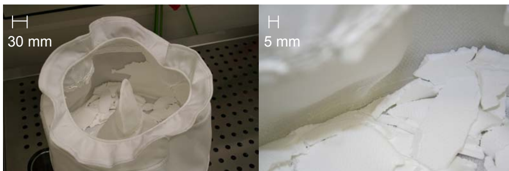
Abb. 5-SS Albumin-Glycin-Filterkuchen nach Vertikalzentrifugation
