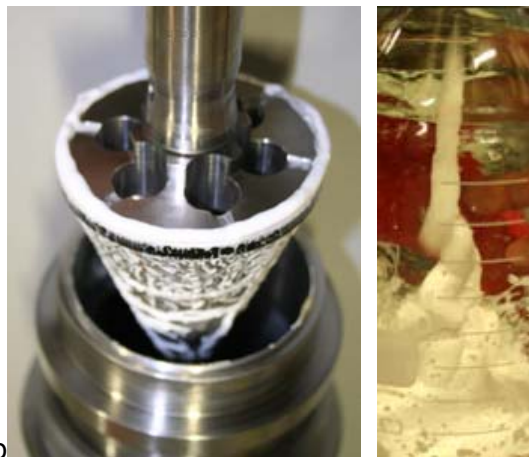
Abb. 4-N a - Kontinuierliche Becherzentrifuge (APD-75, Celeros, JMSeparations), b – Stößel zur Präzipitentleerung und zentrifugierte pastöse PCMC
