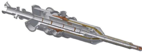
Abbildung 2.3: Der Kryostat für das polarisierte Target. Das eigentliche Target befindet sich in der Spitze der Apparatur (rechts). [Wal08]
