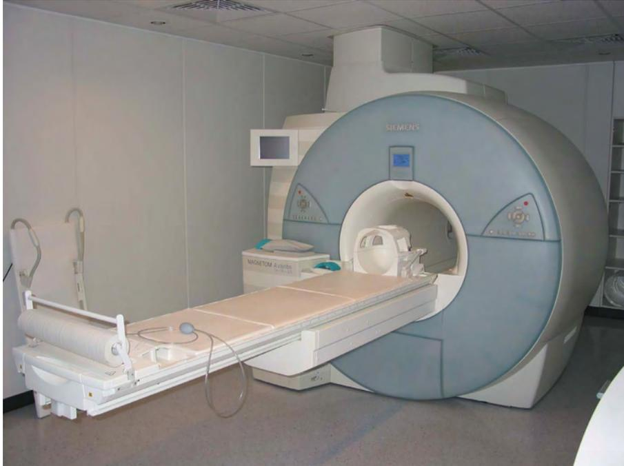
**Abbildung 2.19:** Foto des hauptsächlich genutzten Siemens MAGNETOM Avanto 1,5T Tomographen mit eingebauter Kopfspule im Forschungszentrum Life&Brain.
