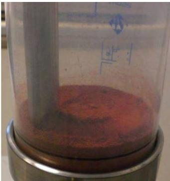
Abb. 3.2-5: Spur des Sondenkopfes in pulverigem Probenmaterial bei der NIRVIS-Messung
