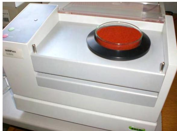
Abb. 3.2-4: Messaufbau NIRFlex N-500; Glasschale mit Probenmaterial in Solids-Aufsatz
