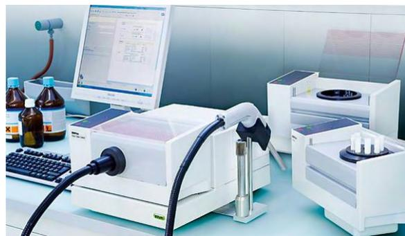
Abb. 3.2-2: NIRFlex N-500 mit Option Lichtleiter, Halterung, sowie beistehend Solids-Aufsatz für Glasschalen, bzw. für Küvetten
