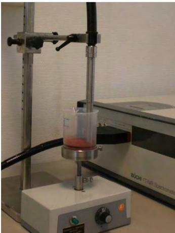
Abb. 3.2-3: Messaufbau NIRVIS; Probenmaterial im Becher auf Drehteller mit eintauchender Sonde
