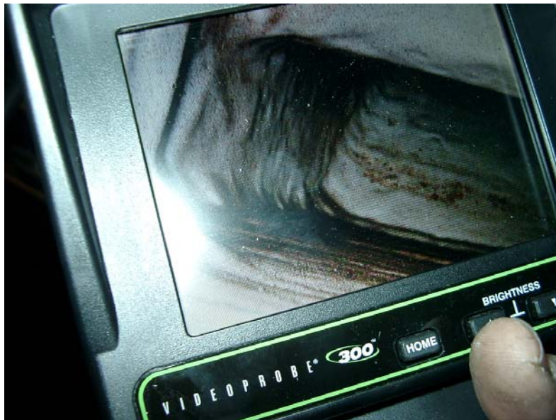
Abb. 2 Endoskopische Aufnahme einer Biofilm-belasteten Frischwasserzelle
