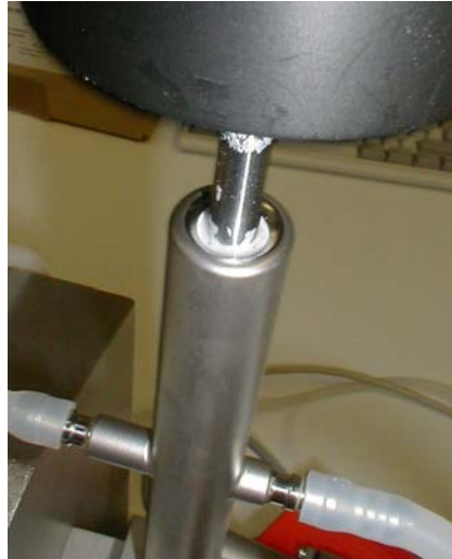
Abbildung 5-61: Foto der Kolbenpumpe mit Lösungsrückstand
