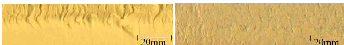
Abbildung 154: Vergleich von Bruchflächen nach einer Vakuumbehandlung von 20 Minuten bei 100 mbar. Links: Aufbereitung in der Trommelmühle, rechts: Aufbereitung im Somakon-Mischer
