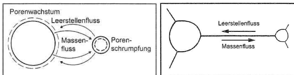
Abbildung 38: Modifiziertes Ostwaldreifungsmodell im Bezug auf Porenwachstum [123].
