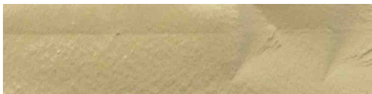
Abbildung 145: Bruchfläche einer getrockneten m-ZTA-Probefläche, die mit optimierten Parametern hergestellt wurde.
