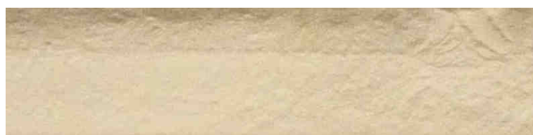
Abbildung 109: Bruchfläche von getrockneten ZTA-Nanocompositkeramiken mit optimierten Parametern hergestellt
