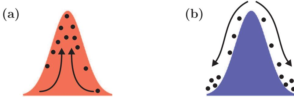
Abb. 2.8: (a) Ein rotverstimmter Laser ( $\Delta < 0$ ) erzeugt ein attraktives Potential. Die Atome sammeln sich im Zentrum des Gaußprofils (b) Ein blauverstimmter Strahl ( $\Delta > 0$ ) erzeugt ein repulsives Potential. Die Atome werden aus dem Zentrum weggedrückt.
