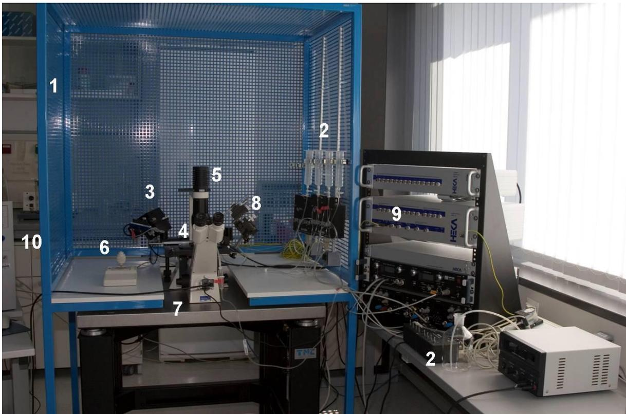
**Abb. 14: Photographische Darstellung des Patch-Clamp-Messplatzes.** 1 Faraday-Käfig, 2 Perfusionssystem, 3 Vorverstärker mit Pipettenhalter und Patchpipette, 4 Perfusionskammer mit Zu- und Ablauf, 5 Inverses Mikroskop, 6 Joystick zur Steuerung der Patchpipette, 7 Schwingungsgedämpfter Tisch, 8 Mikromanipulator, 9 EPC 10 Verstärker mit integriertem AD/DA-Wandler, 10 Computer mit Pulse und Pulse Fit Software zur Datenaufnahme und -analyse
