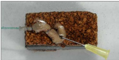
**Abbildung 2:** Darstellung eines exemplarischen Kolonpräparates im Organbad-Setup. Über einen arteriellen Katheter wurde das an beiden Enden mit Ligaturen verschlossene anastomosentragende Kolon ascendens Segment einem konstant ansteigenden intraluminalen Druck bis zum Auftreten einer Leckage ausgesetzt.
