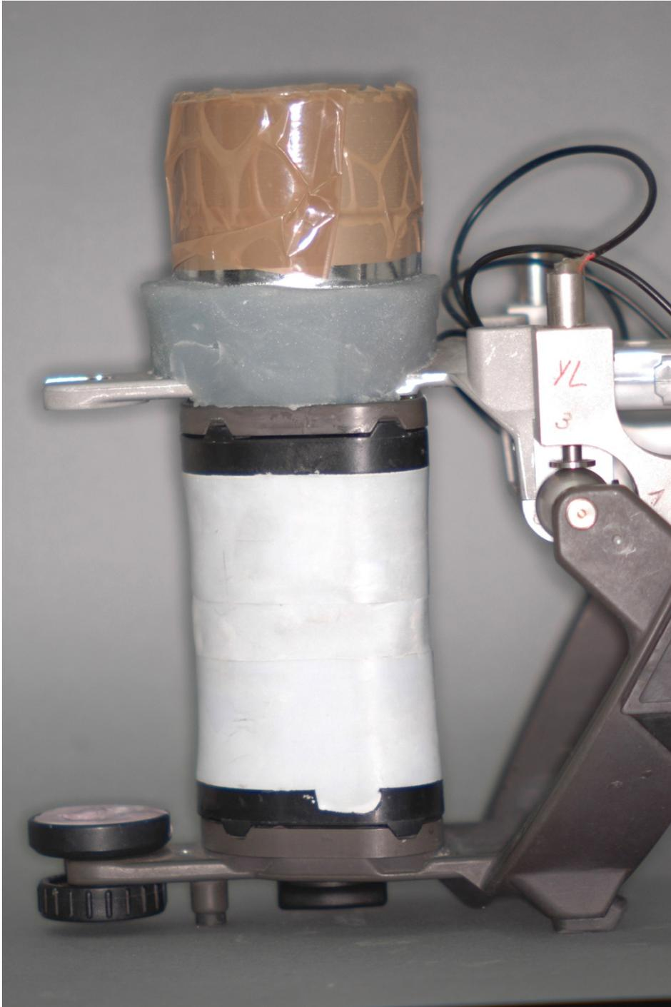
Abb. 3.13 Messartikulator basierend auf dem KaVo® System, mit auf dem Oberteil angebrachten Gewicht, zur Sicherstellung einer gleichbleibenden Belastung bei allen Messungen und eingesetztem Distanzstück
