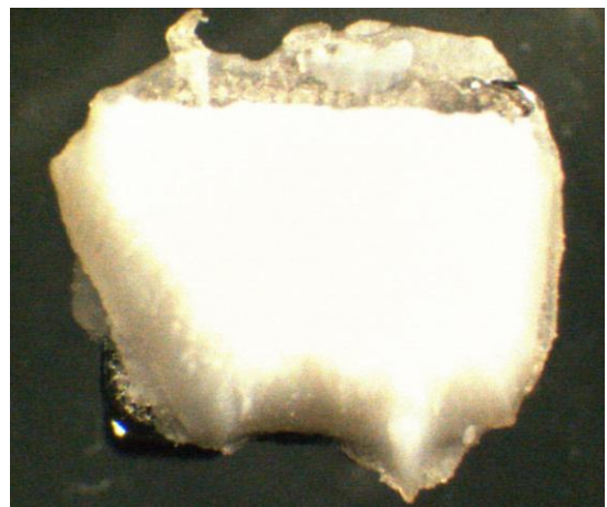
Abb. 33: Haftende Zahnhartsubstanz auf der Bracketbasis nach Probenbruch.
