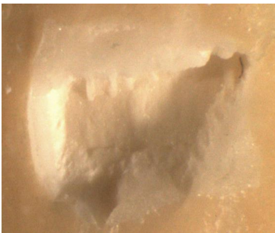
Abb. 32: Makroskopisch sichtbarer Zahnschmelzdefekt nach Probenbruch.
