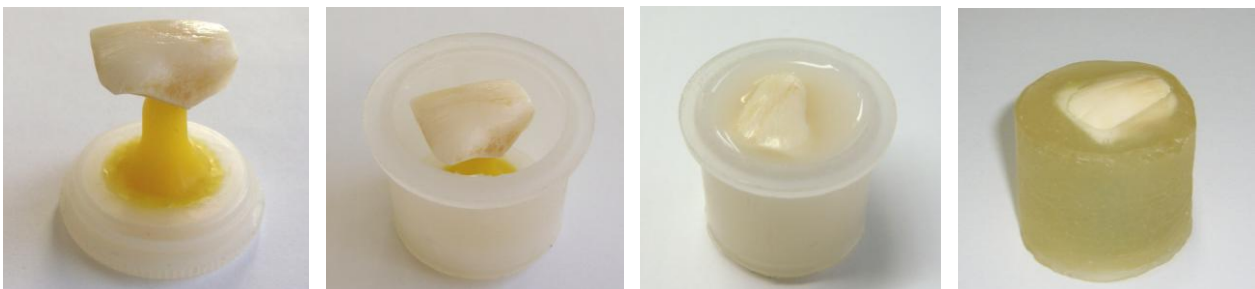
Abb. 6: Die Zähne werden mit Hilfe der PTFE-Grundplatte und dem -Ring Eingebettet. Der Zahn wird auf einem Wachsstumpf ausgerichtet und der Kunststoff in die Form eingegossen.
