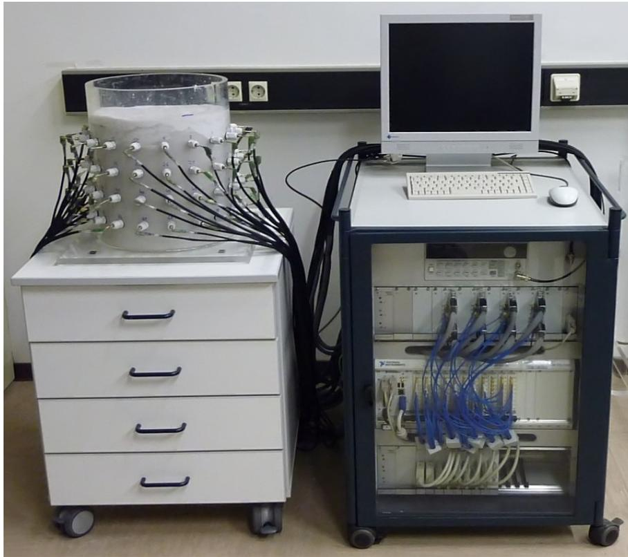
Abbildung 31: Foto des EIT-Messsystems.
