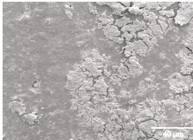
Abb. 32 REM - Aufnahmen der EPDM - Schlauchoberfläche nach der Behandlung mit 100.000 mg/l H 2 O 2 + Fruchtsäuren für 4 Stunden bei 1000x Vergrößerung.
