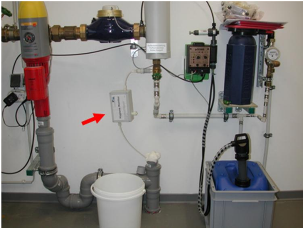
Abb. 35 Hygiene-Monitor mit sterilem Silikonschlauch an der Einimpfstelle.
