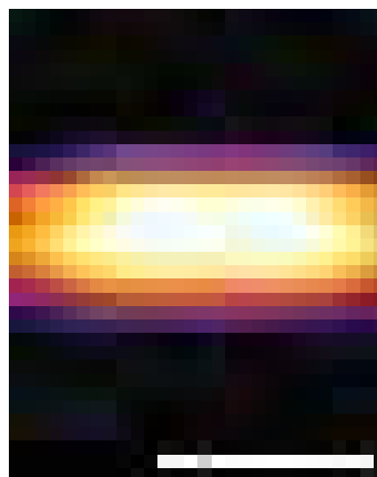
Abbildung 3.5: Darstellung der 2D-PSF aus Abb. 3.4 a gefaltet mit einer Linie. (Falschfarbendarstellung) Maßstab: 500\ \text{nm} .
