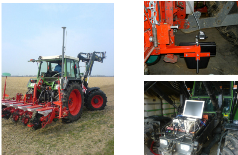
Abb. 5-24: Multi-Sensor-Systems an einer Mehrreihensämaschine
