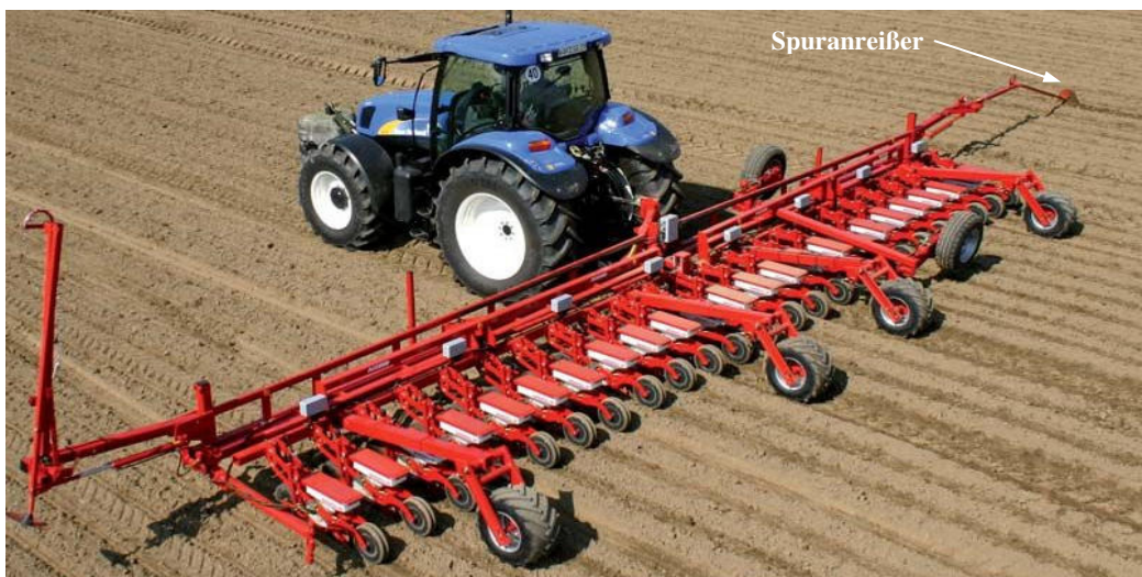
Abb. 1-1: Längsfahrt mit einer konventionellen Mehrreihen-Einzelkornsämaschine, orientiert über Spuranreißer (Quelle: www.kvernelandgroup.com (11.2010))
