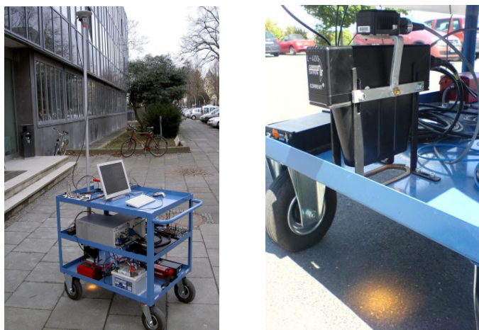
Abb. 4-3: Versuchsträger mit montiertem Multi-Sensor-System
