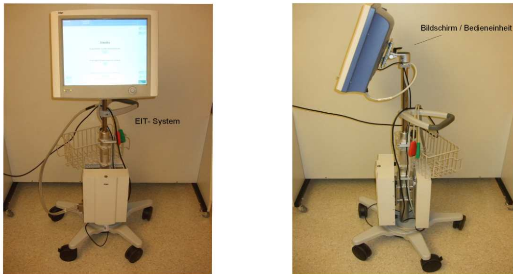
Abb. 6: EIT Evaluation KIT 2 (Dräger Medical, Lübeck, Germany). Zu dem EIT-System gehört ein Multifunktions-Bildschirm, welcher als Bedieneinheit dient und den Rechner enthält. Das System ist auf einem fahrbaren Stativ angebracht und ist somit einfach zu transportieren.
