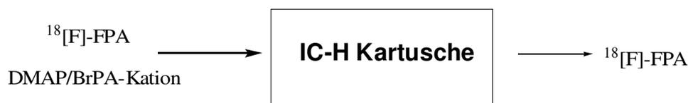
Schema 3.3: Reinigung von  $^{18}\text{F}$ -FPA mittels Kationenaustauscher IC-H (stark saurer).  $^{18}\text{F}$ -FPA, BrPA-Kation (derivatisierter Precursor) und DMAP werden durch eine IC-H Kartusche gespült wobei nur das DMAP und das BrPA-Kation auf der IC-H fixiert werden. Das  $^{18}\text{F}$ -FPA passiert die IC-H und kann auf einer nachfolgenden C18 Kartusche fixiert werden und nach Bedarf reeluiert werden.
