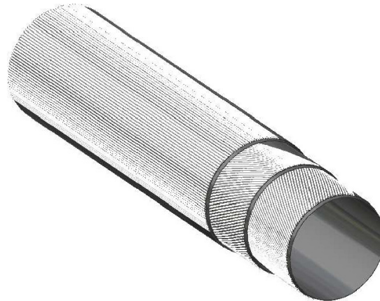
Abbildung 3.14.: Der Innendetektor mit seinen drei Lagen aus szintillierenden Fasern. Die äußerste Lage ist parallel zum Strahl ausgerichtet, die beiden inneren Lagen sind in verschiedene Richtungen um circa 25^\circ dazu gedreht.
