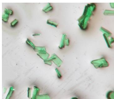
Abbildung 2.16 – Plättchenförmige Kristalle der Verbindung  $\text{Li}[\text{MoOCl}_4]$ .
