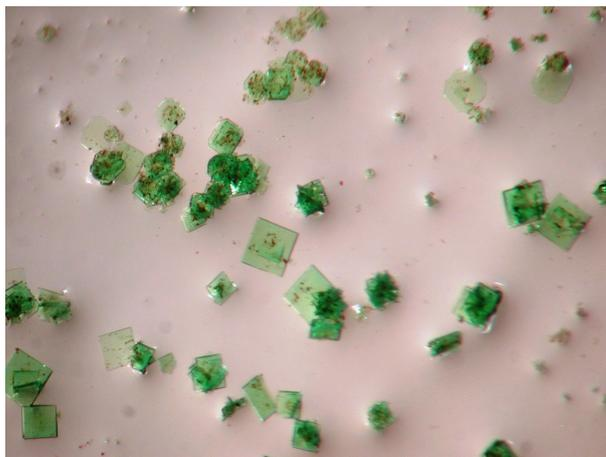
**Abbildung 2.64** – Aufgrund der Schichtdicke transparente hellgrüne tafelförmige Kristalle der Bariumverbindung. Durch den tafelförmigen Habitus der Kristalle mit quadratischen Hauptflächen kann auf ein höher symmetrisches Kristallsystem geschlossen werden.
