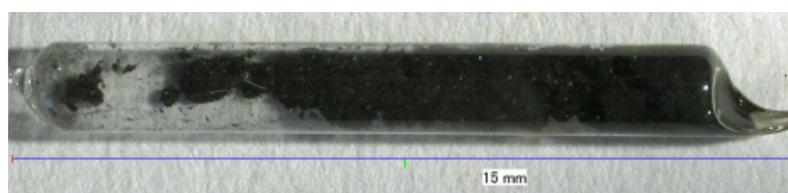
**Abbildung 2.81** – (TTF)[MoOCl<sub>4</sub>] in der abgeschmolzenen Quarzglaskapsel, die für die magnetischen Untersuchungen verwendet wurde.
