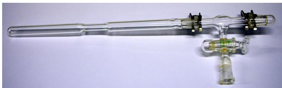
**Abbildung A.2** – Die für die Solvothermalsynthese verwendeten Halbbampullen mit aufgesetztem T-Stück.
