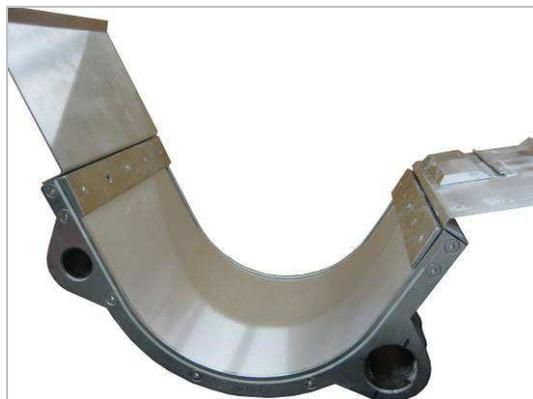
Abb. 4.31. Aluminiumblech als „Blindsieb“
