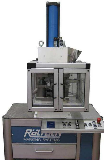
Abb. 3.6. pneumohydraulische Tablettenpresse Flexitab
