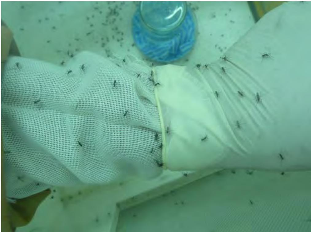
**Abbildung 58: Mit Etofenprox imprägniertes Moskitonetz im „Arm-in-Cage“ Versuch**
