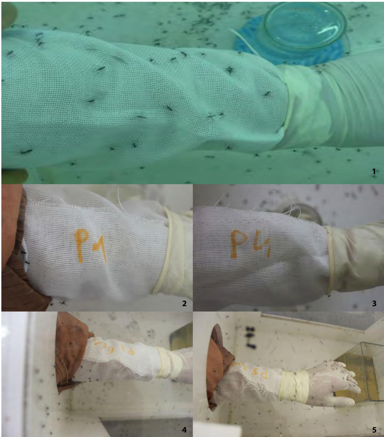
**Abbildung 66: „Arm-in-Cage“ Tests: 1: Unimprägniertes Netz, 2: Netz mit etwa 5000 mg/m<sup>2</sup> IR 3535, 3: Netz mit etwa 6700 mg/m<sup>2</sup> IR 3535, 4: Netz mit etwa 1500 mg/m<sup>2</sup> IR 3535 und 10 mg/m<sup>2</sup> Permethrin, 5: Netz mit etwa 3600 mg/m<sup>2</sup> Diethyltoluamid und 1200 mg/m<sup>2</sup> Permethrin,**
