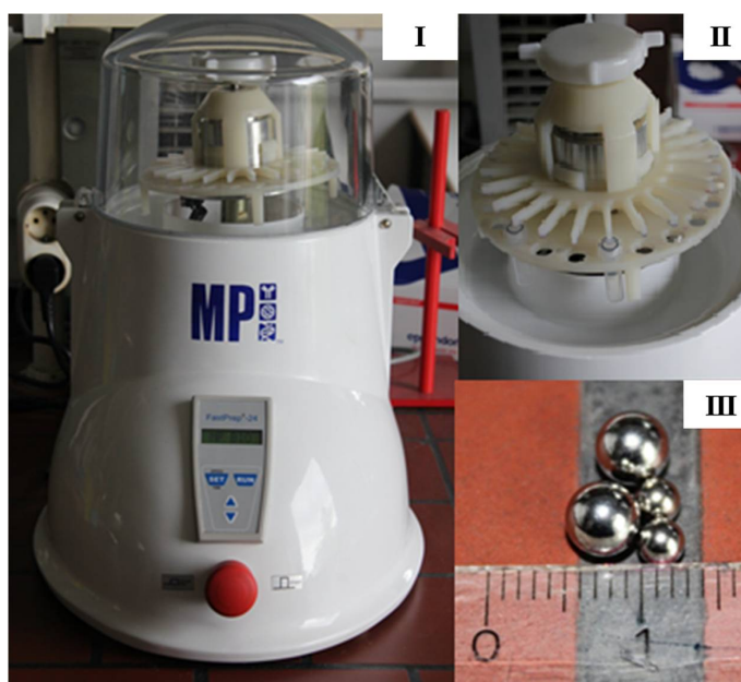
Abbildung 6.4: Kugelmühle Fast Prep-24 (MP-Biomedicals) (I), Nahansicht mit 24er Probenhalter und Mahlgefäßen (II), Kugeln aus rostfreiem Stahl ( \varnothing = 3 mm/5 mm) (Retsch) (III).
