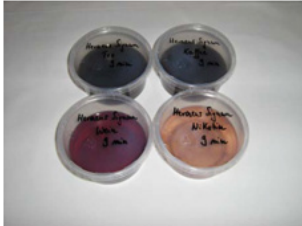
Abb. 5: Kunststoffbehälter mit Verfärbungsflüssigkeiten und inliegenden Prüfkörpern
