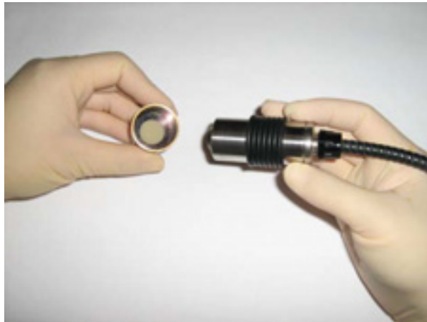
Abb. 6: Messung eines Prüfkörpers mit dem Spectrophotometer im Metallzylinder
