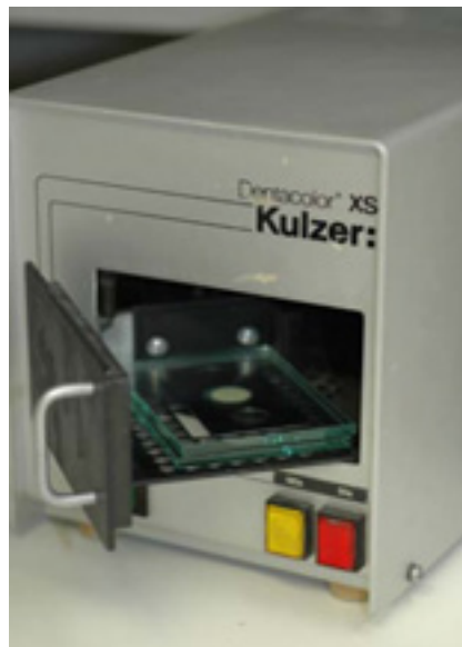
Abb. 4: UV-Lampe Dentacolor XS mit inliegender Probenherstellungform vor der Aushärtung
