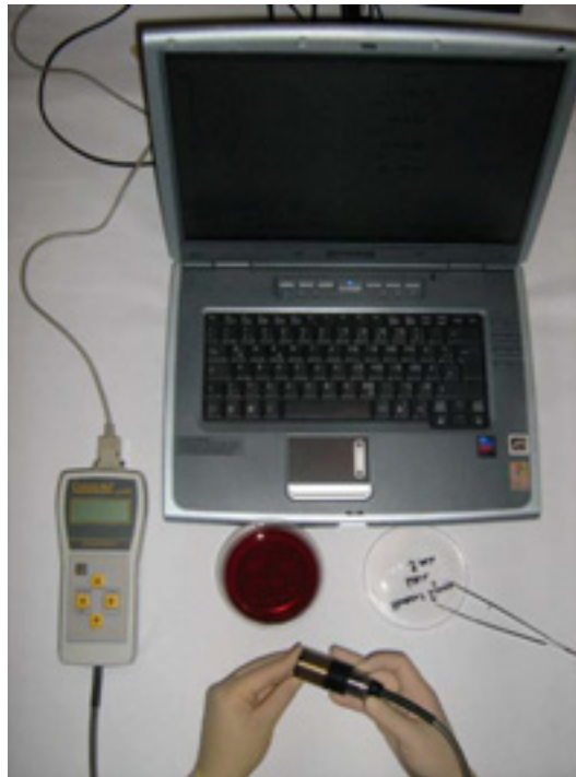
Abb. 7: Messvorgang mit dem Spectrophotometer und unmittelbarer Datenübertragung auf einen Personalcomputer
