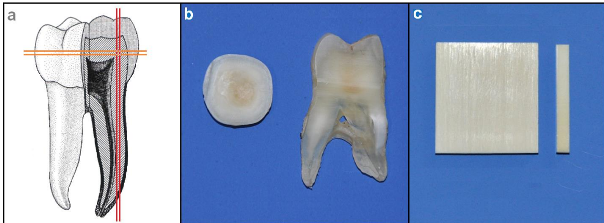
Abb. 13: Probenanfertigung. In a wird in orange die horizontale und in rot die vertikale Schnittführung von Zahnproben dargestellt (Abbildung a nach Schumacher et al., 1990). In b ist exemplarisch ein horizontaler Zahnschnitt eines Prämolaren (links, 1mm dick) und ein vertikaler Zahnschnitt eines Molaren (rechts, 1mm dick) dargestellt. Bild c zeigt exemplarisch einen Elfenbeinblock und einen für den Versuch auf 1 mm zugeschnittenen Probekörper (rechts). Gut zu erkennen ist die Homogenität der Elfenbeinprobe (c) im Vergleich zur Zahnprobe (b)
