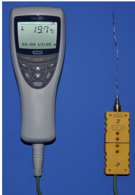
Abb. 11: Thermometer (Jumo TDA-3000, Jumo GmbH & Co. KG, Fulda) mit NiCr-Ni-Temperaturfühler
