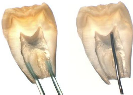
**Abb. 4:** Darstellung zweier Hälften eines Zahnes: In der einen Hälfte befinden sich zwei Kanülen, in der anderen Hälfte die Temperaturmesssonde.
