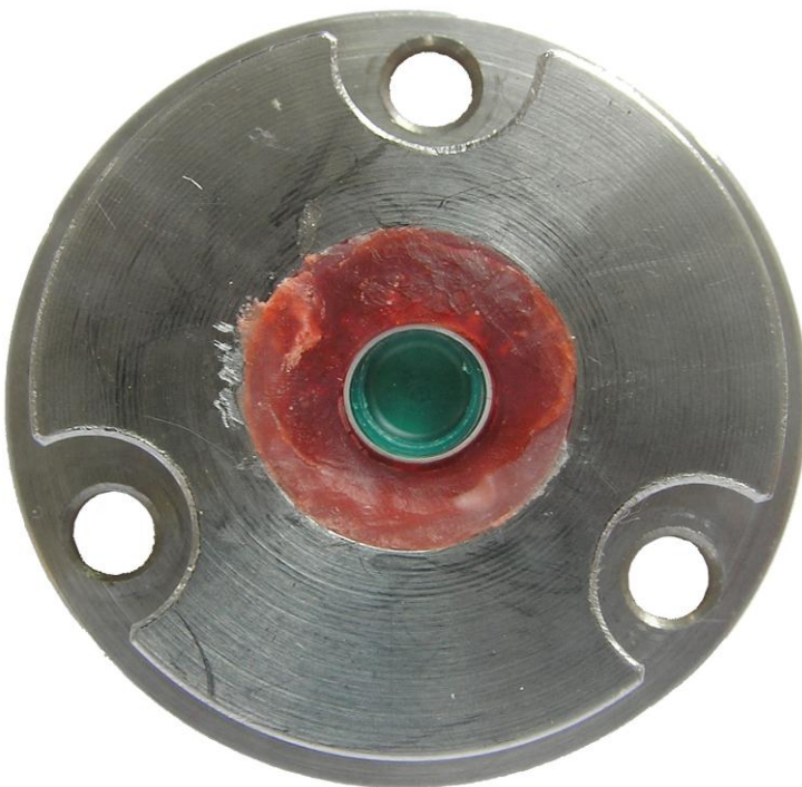
Abb. 11: In Probenhalter einpolymerisierte Matrize (grünes Insert)
