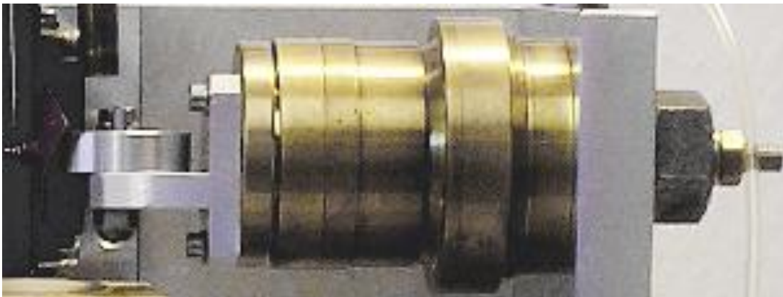
Abb. 8: Parodontienadäquate Aufhängung zur Simulation des Zahnhalteapparates
