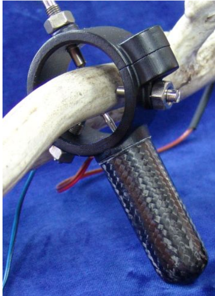
Abbildung 17: Die Belastungseinheit besteht aus einem Trägerring und einem Linearmotor, der vertikal an diesem angebracht ist (links). Die Belastungseinheit wird mit Hilfe des Trägerrings an dem Geweih befestigt, indem dieser mit drei Kortikalisschrauben, die eine um 120° versetzte Anordnung aufweisen, fixiert wird.
