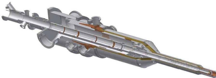
Abbildung 3.8: Strahlachsensymmetrischer Kryostat für das polarisierte Target [Wal07].
