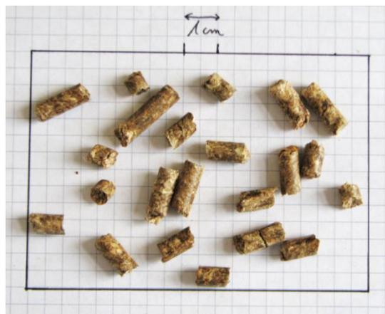
Abbildung 47: Optimierte Miscanthus-Paulownia-Mischpellets, die unter den in Tabelle 11 (Versuchsnummer 4) dargestellten Bedingungen, während des Vorversuches bei Amandus Kahl produziert wurden
