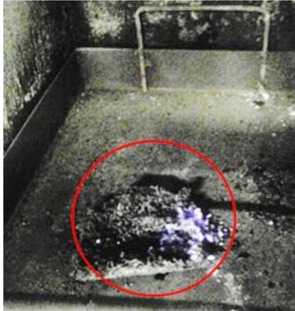
Abbildung A7: Verschlackung der Asche während eines ersten Verbrennungsversuches von Miscanthus-Mischpellets (50 M.-% Miscanthus / 50 M.-% Paulownia) durch die FH Köln (Bild: Steinbüchel, 2011)
