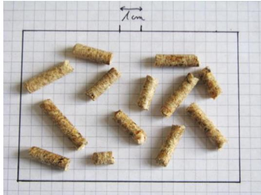
Abbildung 48: Miscanthus-Fichten-Mischpellets, die unter den in Tabelle 11 (Versuchsnummer 8) dargestellten Bedingungen während des Vorversuches bei Amandus Kahl produziert wurden
