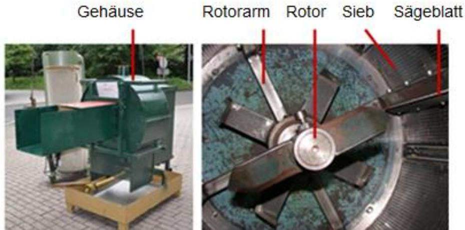
Abbildung 8: Trockenzerfaserung 22/600 der FH Köln, links: Außenansicht und rechts: Innenansicht
