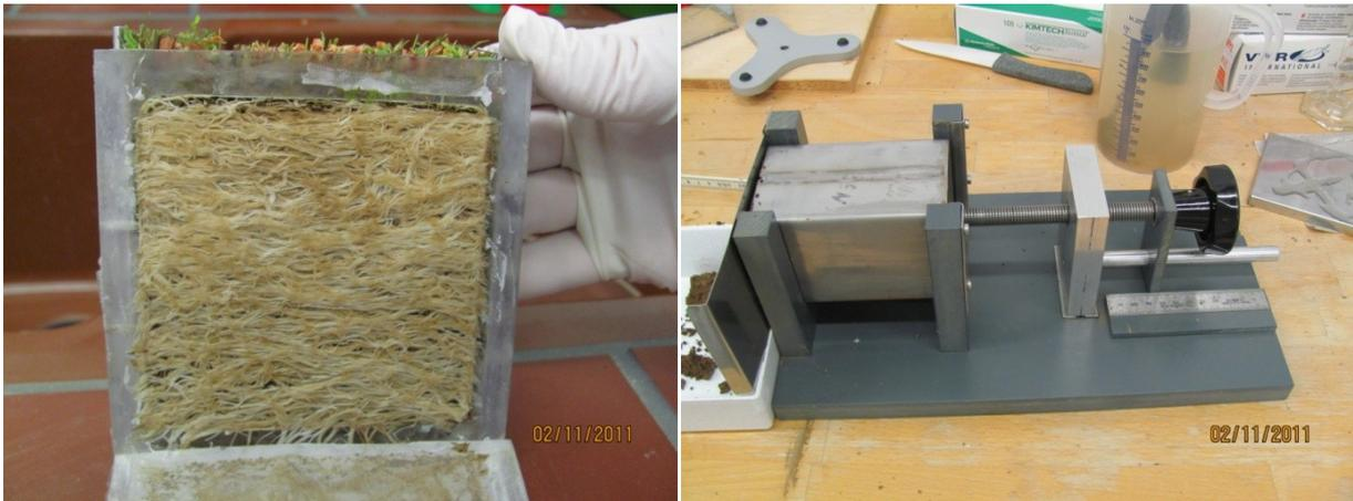
**Abb. 3.8:** Wurzelmatte der Luzerne (links) und Schneidevorrichtung mit eingespanntem Stechzylinder.
