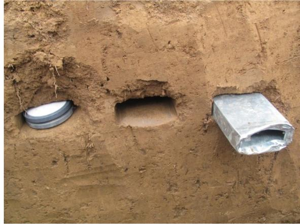
**Abb. 3.3:** Fotoaufnahme des Diffusionstascheneinbaus. Rechts: rechteckiger Stechzylinder, Mitte: Aussparung für die Diffusionstasche, links: Diffusionstasche vor vollständigem Einschub in die Aussparung.
