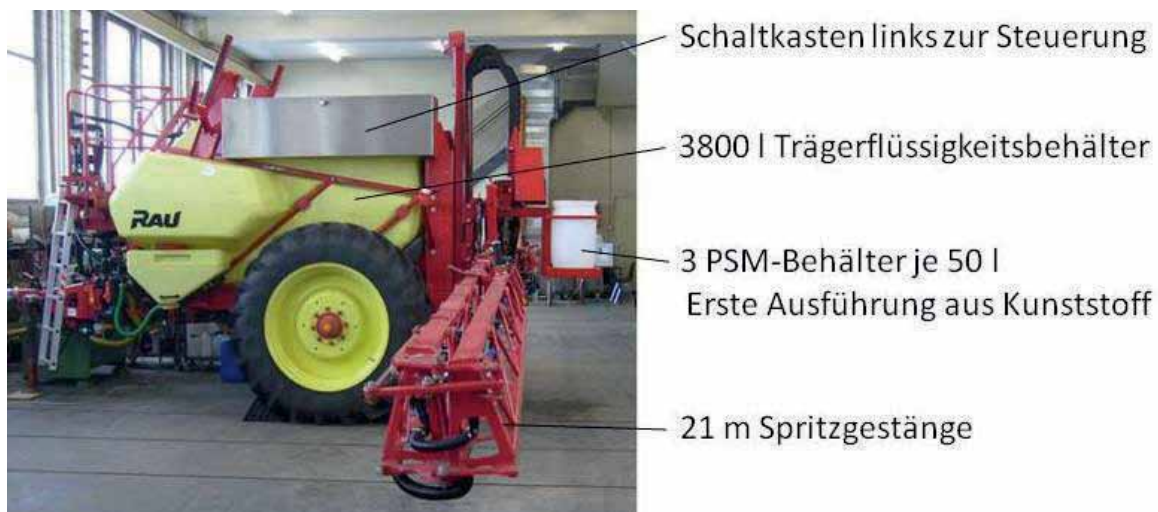
Abb. 5: Gesamtansicht des Versuchsträgers mit Schaltkasten und PSM-Behälter
