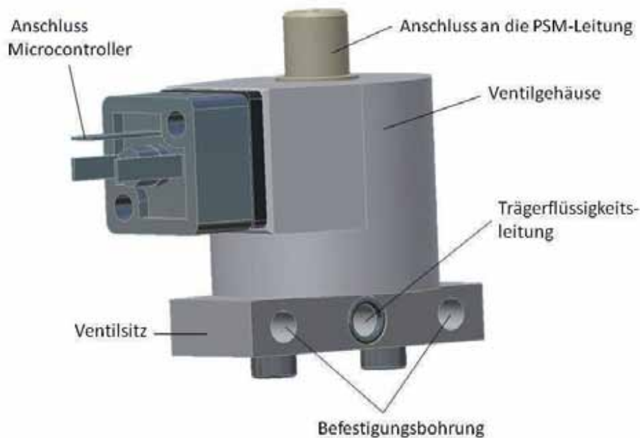
Abb. 18: Aufbau des Einspeisungsventils
