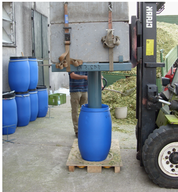
Abbildung 4: Silageverdichtung im Kleinsilo mittels Gabelstapler
