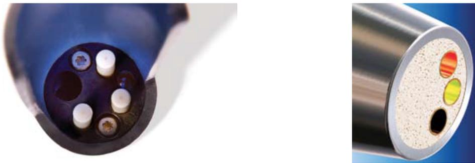
**Abb. 10:** Die linke Abbildung zeigt das fiberoptische Element des Midwest Caries I.D. in Aufsicht. Rechts sind die zwei Lichtemitter (rot und grün) und der Lichtsensor (schwarz) schematisch dargestellt (Quelle: Dentsply, York, Großbritannien).
