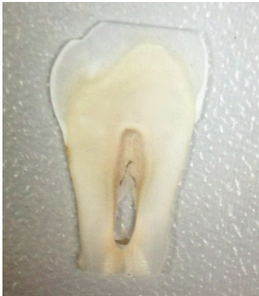
Abb. 8: Probekörper mit der Schichtdicke 0,5 mm. Deutlich im Bild zu sehen von oben nach unten: Schmelzschicht, dicke Dentinschicht und leeres Pulpacavum
