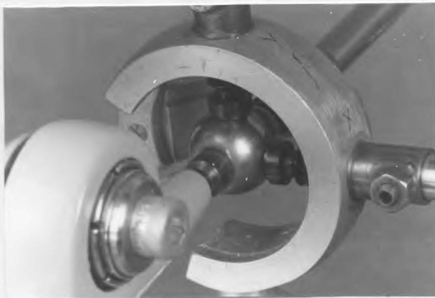
Abb. 2b: Detailaufnahme der Tastköpfe der induktiven Wegaufnehmer und der Kondylarkugeln.
