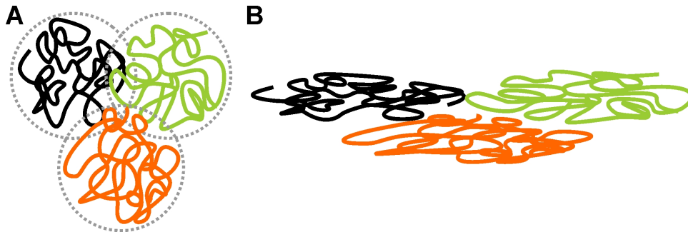
Abbildung 7.1: A. Drei Makromoleküle, beispielsweise Proteine, befinden sich im Ruhezustand in kompakter Form, mit verknäuelten und ineinander verhakten Kettenbereichen. Aufgrund der Verklumpung ist die Zähflüssigkeit hoch. B. Unter Scherbelastung können die Moleküle eine gestreckte, orientierte Form mit weniger verschlauferten Kettenbereichen annehmen. Die Zähflüssigkeit ist aufgrund der Formation der Moleküle verringert (verändert nach Mezger (2006) ).
