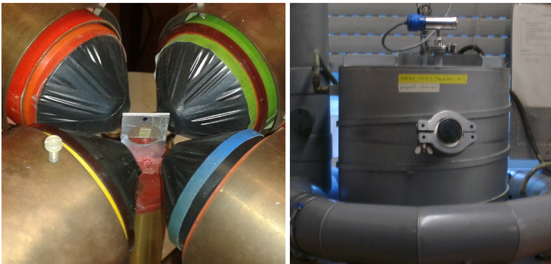
(a) Probe unter 45^\circ zu den Detektoren
