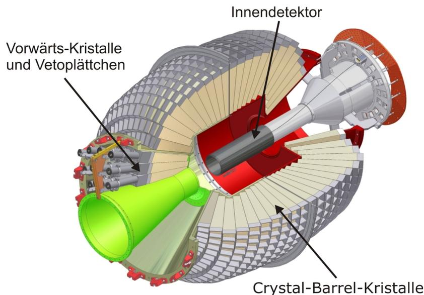
**Abbildung 1.13:** Der Crystal-Barrel-Detektor mit Innen- und Vorwärtsdetektor [34].
