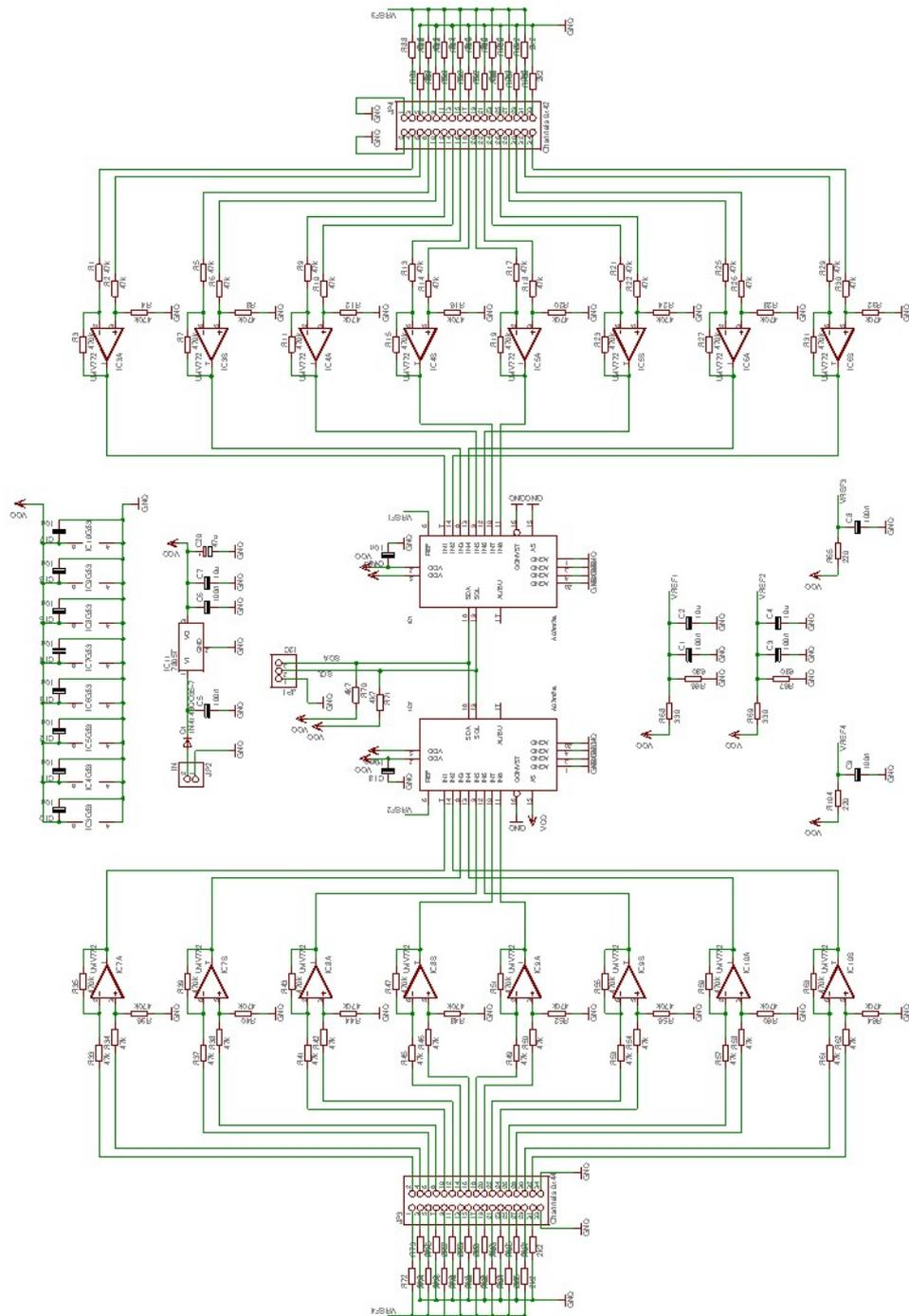
Abbildung A.1: Schaltplan der Pt100-Ausleseplatine
