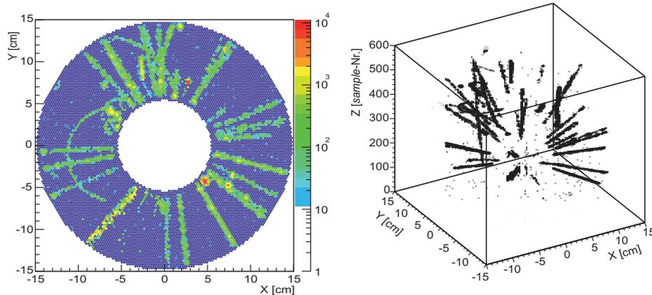
**Abbildung 2.20:** Projektion auf die Ausleseebene (links) und dreidimensionale Rekonstruktion (rechts) eines typischen Ereignisses in der GEM-TPC, hervorgerufen durch einen  $^{22}\text{Ne}$ -Strahl an einem Aluminiumtarget.
