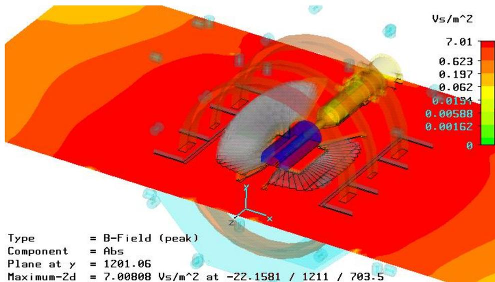
**Abbildung 2.27:** CST-Simulation eines 7 T starken Magnetfeldes im Bereich des Rückführjochs mit Crystal-Barrel-Detektor (grau), Targetkryostaten (gelb) und einem Dummyvolumen für die TPC (blau). Der Magnet wird von drei supraleitenden Spulen gebildet (orange Ringe).
