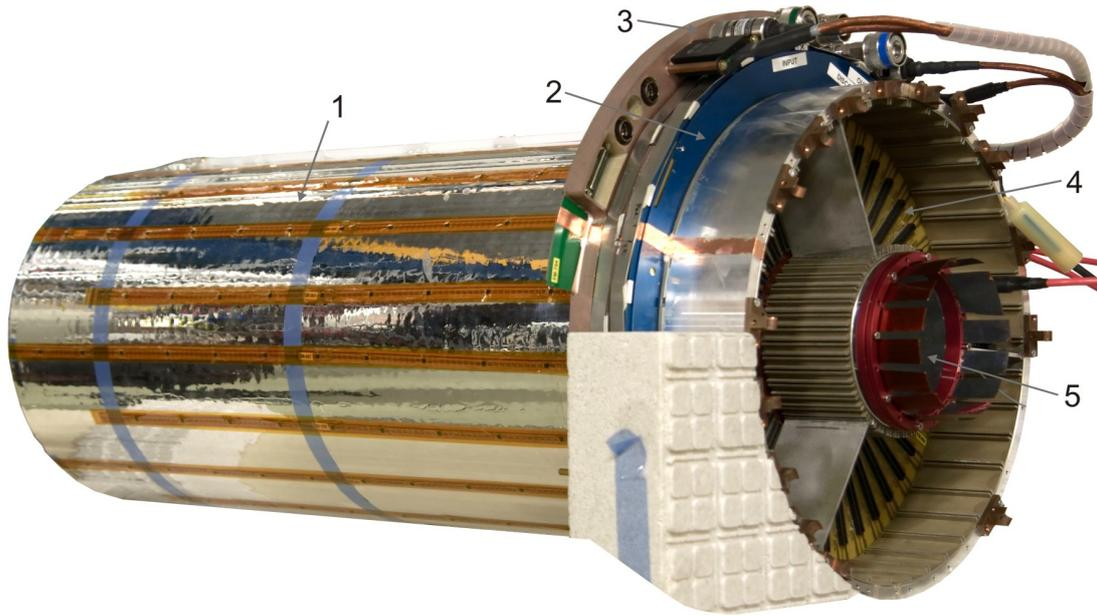
**Abbildung 2.18:** Zusammengebaute GEM-TPC mit äußerem (1) und innerem (5) Feldkäfig, GEM/Auslese- (2) und Media-Flansch (3). Auf der Rückseite der Ausleseebene sind die Steckplätze (4) für die Front-End-Karten zu erkennen.
