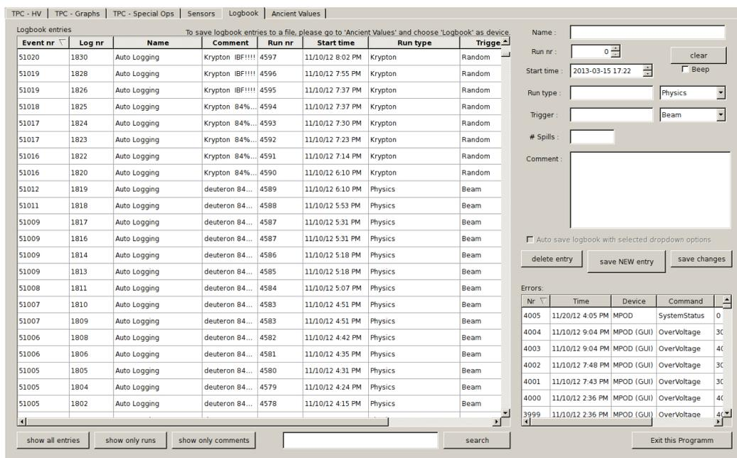
**Abbildung C.12:** Auf der ‘Logbook’-Registerkarte können neue Einträge zum Logbuch hinzugefügt (rechts) sowie alte Logbuch-Einträge (links) und vom Daemon erkannte Fehler (rechts unten) untersucht werden.
