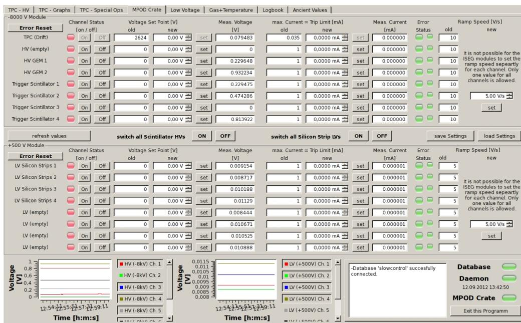
Abbildung C.16: Registerkarte 'MPOD Crate' zur Steuerung und Überwachung des 8 kV- (oben) und des 500 V-Moduls (unten) im MPOD-Crate.
