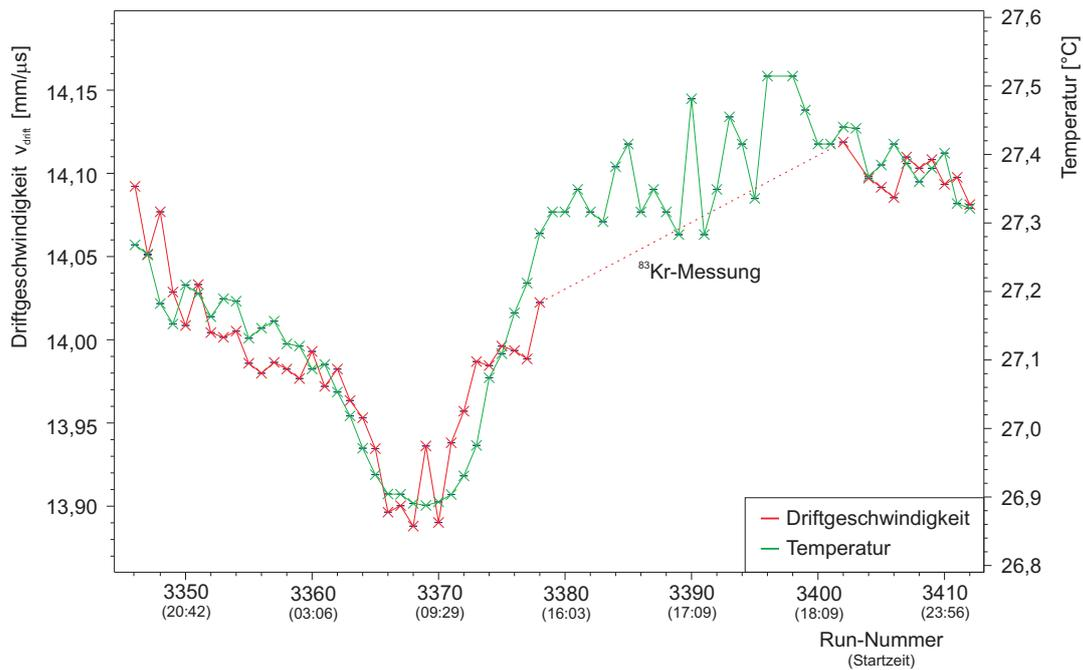
**Abbildung 7.9:** Verlauf der rekonstruierten Driftgeschwindigkeit (rot) und der gemessenen Temperatur (grün) über einen Zeitraum von 28 Stunden. Der Fehler der Driftgeschwindigkeit wurde aus Gründen der Übersichtlichkeit weggelassen.
