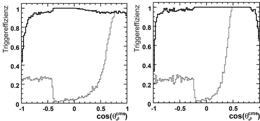
**Abbildung 1.19:** Simulation der Triggereffizienz für die Reaktion  $\gamma n \rightarrow n \pi^0$  für Photonenergien von 700 MeV (links) beziehungsweise 2 GeV (rechts). Die gestrichelte Linie gibt die derzeit mögliche, die durchgezogene Linie die nach dem Umbau erwartete Effizienz an [54].
