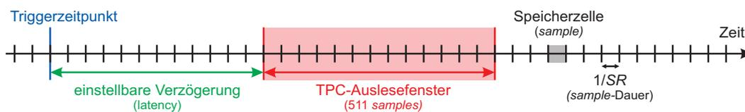
**Abbildung 7.2:** Die 511 Speicherzellen im Analog-Ring-Speicher werden kontinuierlich mit neuen Daten überschrieben. Ausgelöst durch ein Triggersignal werden die aktuellen *samples* (rote Markierung) durch den ADC ausgelesen und digitalisiert.
