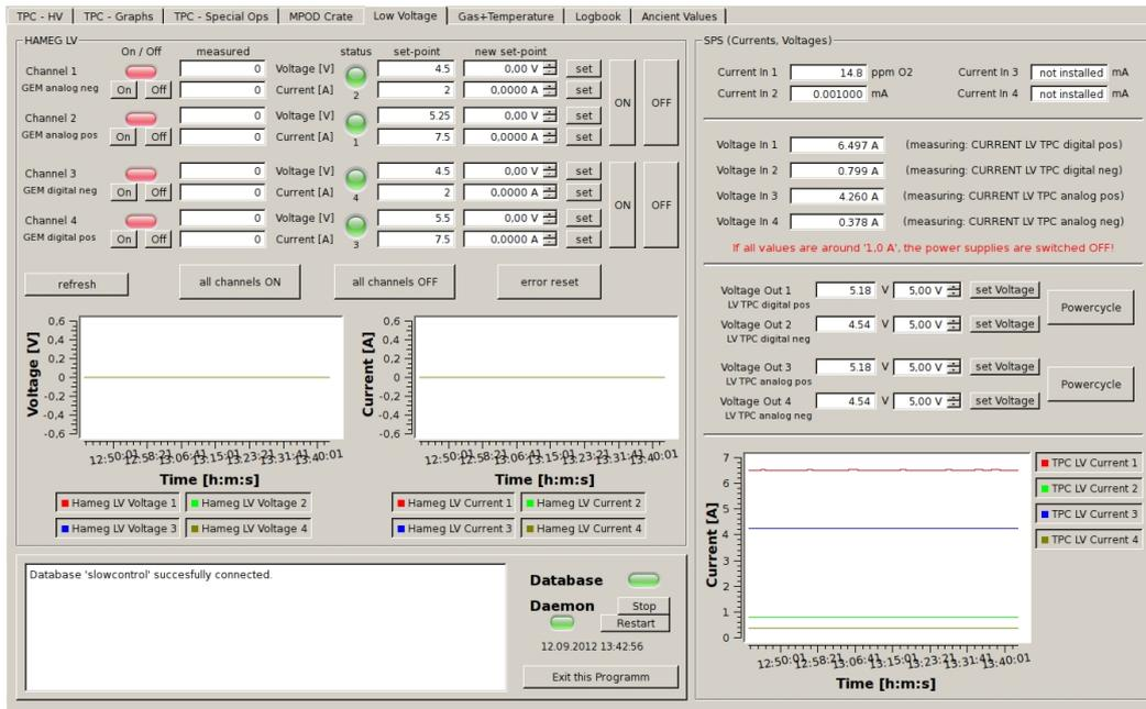
**Abbildung C.17:** Über die Registerkarte ‘Low Voltage’ lassen sich das HAMEG HMP4040-Labornetzgerät (links) und die Spannungen und Ströme an der SPS einstellen und überwachen.
