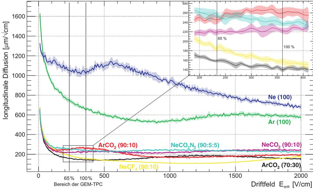
**Abbildung 3.2:** Simulation der longitudinalen Diffusion in verschiedenen Gasmischungen unter Standardbedingungen und einer Magnetfeldstärke von  $B_Z=2$  T.
