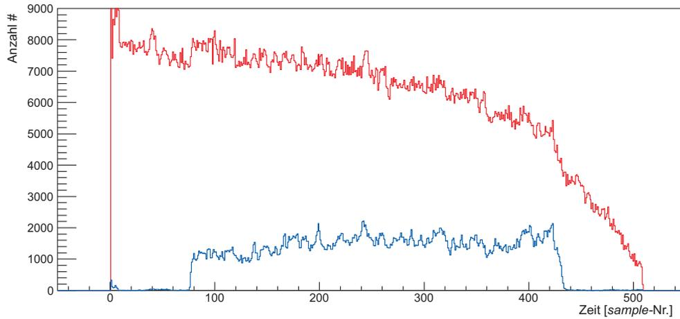
**Abbildung 7.3:** Zeitspektrum mit (blau) und ohne (rot) durchgeführte Schnitte. Die Daten wurden mit der GEM-TPC mit kosmischer Strahlung bei einem Driftfeld von 360 V/cm und ArCO<sub>2</sub> (90:10) als Driftgas aufgenommen.
