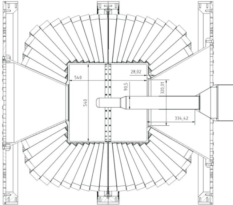
**Abbildung 2.1:** Schematische Zeichnung des Crystal-Barrel-Detektors mit Abständen und Innenmaßen in Millimetern [34]. Das Targetrohr mit einem Durchmesser von 90,5 mm und die Aussparung in der Halterung der Crystal-Barrel-Kristalle mit einer Öffnung von 320 mm legen die absoluten geometrischen Grenzen für einen Spurdetektor im Inneren des Crystal-Barrel-Detektors fest.
