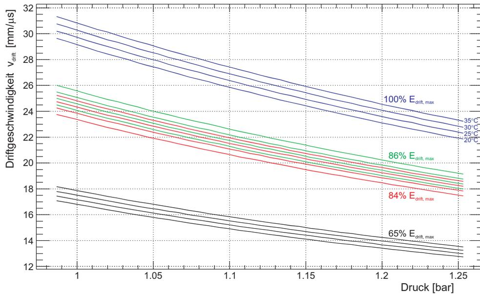
**Abbildung 3.10:** Abhängigkeit der Elektronendriftgeschwindigkeit in ArCO<sub>2</sub> (90:10) vom Druck bei verschiedenen Driftfeldern und Temperaturen.
