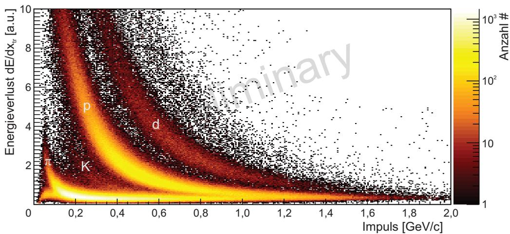
**Abbildung 7.16:** Spezifischer Energieverlust  $dE/dx$  geladener Teilchen in der GEM-TPC in Abhängigkeit vom ihrem Impuls bei einem Magnetfeld von 0,6 T und  $\text{ArCO}_2$  (90:10) als Driftgas [131].
