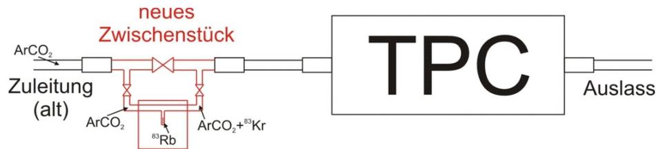
**Abbildung 2.21:** Integration der  $^{83}\text{Rb}$ -Quelle in das Gassystem der GEM-TPC. Das innere Stahlröhrchen mit der radioaktiven Quelle ist über einen Bypass an das Gassystem der GEM-TPC angeschlossen, so dass über drei Gashähne zwischen normalem Betrieb und Gasfluss durch den Aufbewahrungsbehälter gewählt werden kann.
