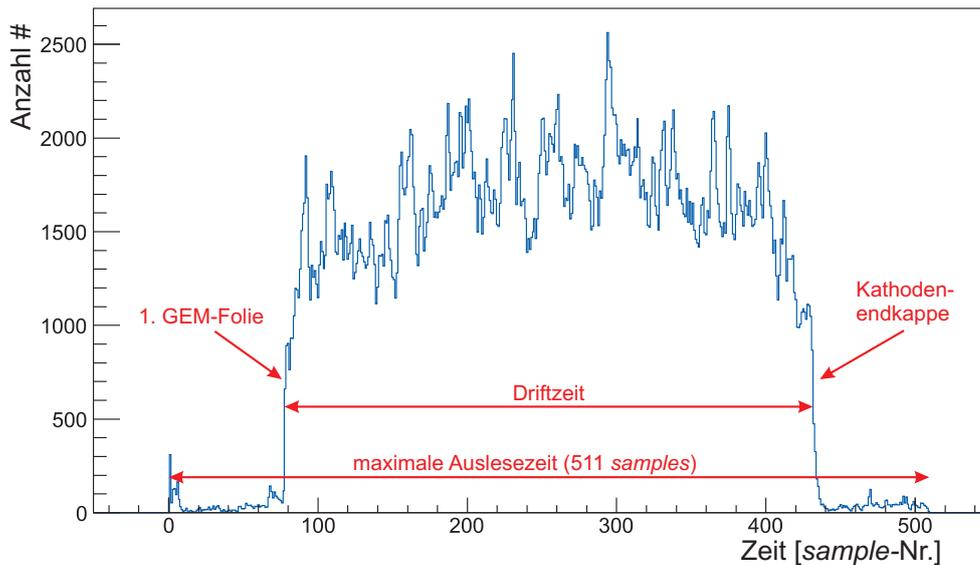
**Abbildung 7.1:** Bestimmung der Driftgeschwindigkeit aus den Daten: Im einfachsten Fall können die Kathodenendkappe und die erste GEM-Folie als klare Kanten im Zeit-Spektrum identifiziert und aus deren Abstand die Driftzeit bestimmt werden. Die 511 *samples* entsprechen für den dargestellten Run einer maximale Auslesezeit von  $32,86 \mu\text{s}$ .
