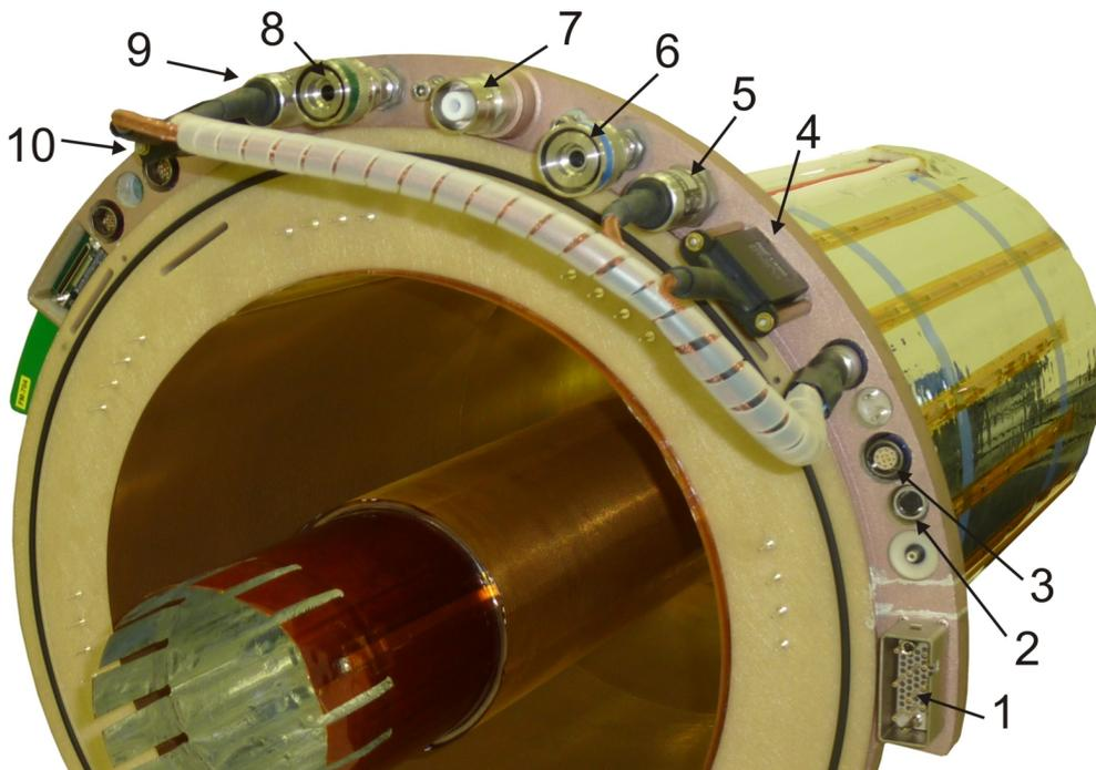
**Abbildung 2.17:** Media-Flansch mit Gasauslass (6) und -einlass (8), Druck- und Flussensoren (5 und 9 beziehungsweise 4 und 10), Hochspannungsanschluss für den Feldkäfig (7) und die GEM-Folien (1) und Abgriffe für die Signale der Temperatursensoren am Feldkäfig (2) und der Gassensoren (3).
