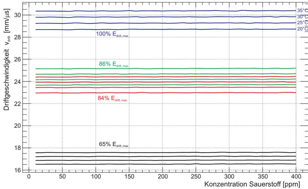
**Abbildung 3.14:** Abhängigkeit der Elektronendriftgeschwindigkeit in ArCO<sub>2</sub> (90:10) von der Sauerstoffkonzentration im Driftgas bei verschiedenen Driftfeldern und Temperaturen.
