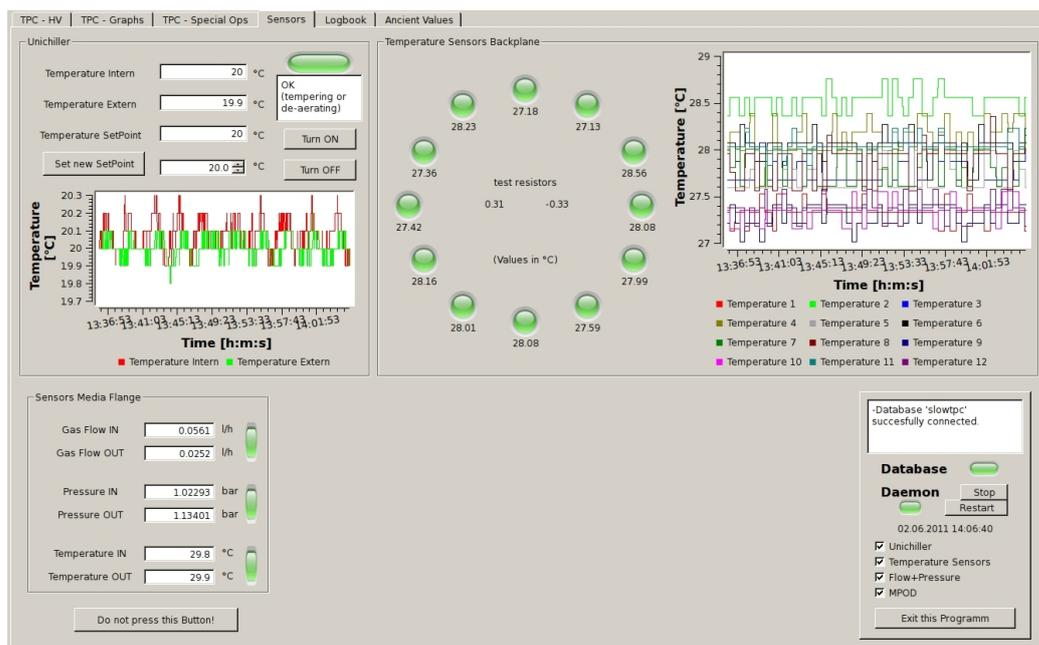
**Abbildung C.11:** Die Einstellungen des Unichillers können auf der Registerkarte ‘Sensors’ vorgenommen werden (links oben). Zudem sind hier die Temperaturen auf Ausleseebene (rechts oben) und die Werte der Sensoren auf dem Media-Flansch (links unten) dargestellt.
