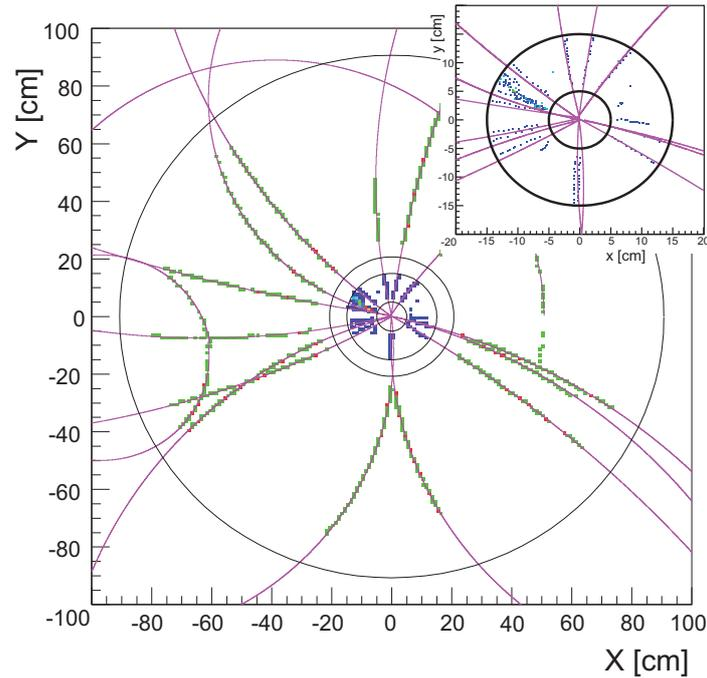
**Abbildung 7.14:**  $x$ - $y$ -Projektion eines angepassten Ereignisses in der GEM-TPC (innere Ringe, blaue Punkte) und der CDC (äußere Ringe, grüne Punkte) mit den rekonstruierten Teilchenspuren (blaue Linien).
