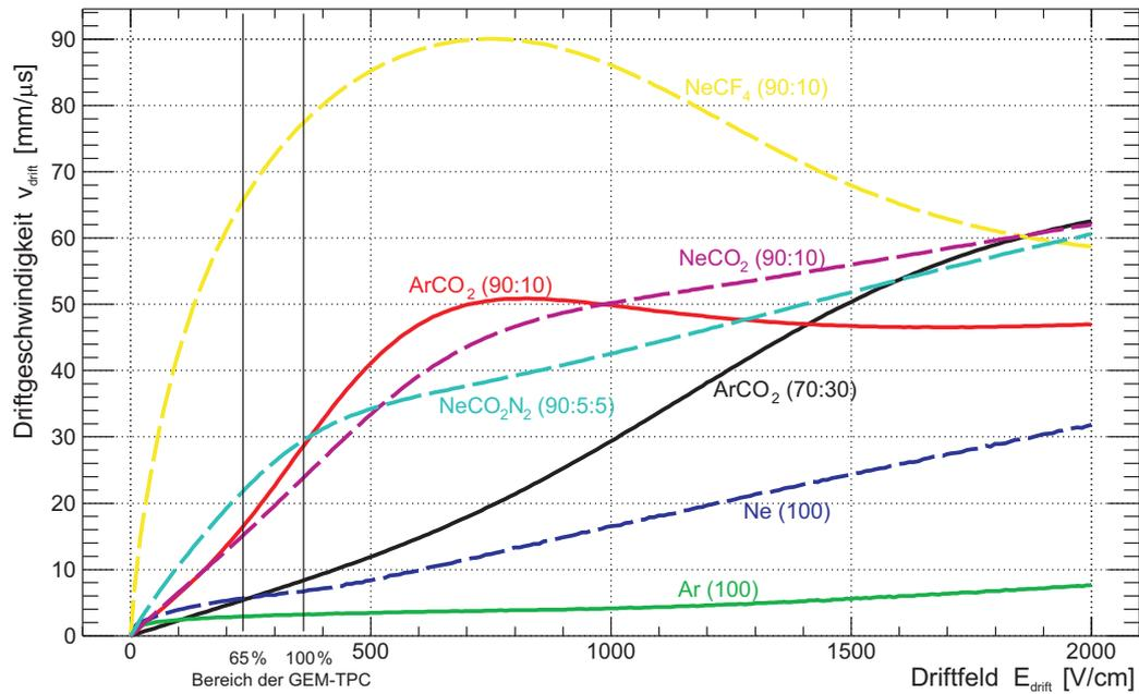
**Abbildung 3.6:** Elektronendriftgeschwindigkeit in verschiedenen Gasgemischen in Abhängigkeit vom angelegten Driftfeld unter Standardbedingungen und einer Magnetfeldstärke von  $B_z=2 \text{ T}$ .
