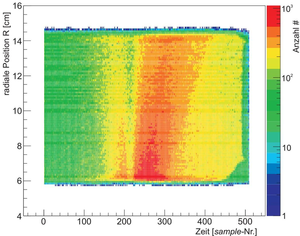
**Abbildung 7.11:** Logarithmisch dargestellte Häufigkeit der Driftzeit in Abhängigkeit von der radialen Position der rekonstruierten Cluster für Run 3572 ( $\pi^-$ -Strahl, Kupfertarget, 234 V/cm, ArCO<sub>2</sub> (90:10)).
