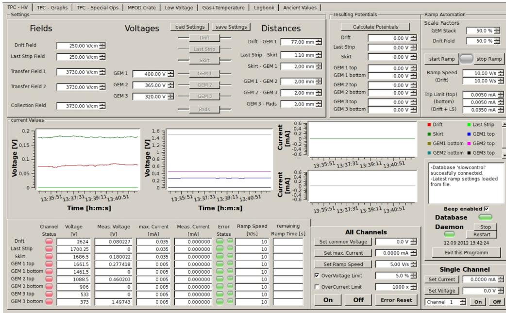
Abbildung C.15: Registerkarte 'TPC - HV' zur Steuerung und Überwachung der Spannungen, Ströme und Rampgeschwindigkeiten der Test-TPC.
