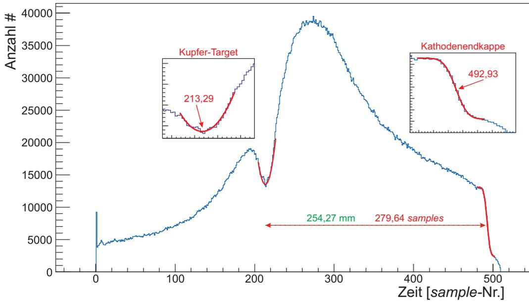
**Abbildung 7.6:** Zeitspektrum für Run 3572 mit angepasster Stufenfunktion zur Bestimmung der Position der Kathodenendkappe sowie angepasster Parabel für die Position des Kupfertargets. Die Daten wurden mit der GEM-TPC mit einem  $\pi^-$ -Strahl bei einem Driftfeld von 234 V/cm und ArCO<sub>2</sub> (90:10) als Driftgas aufgenommen.
