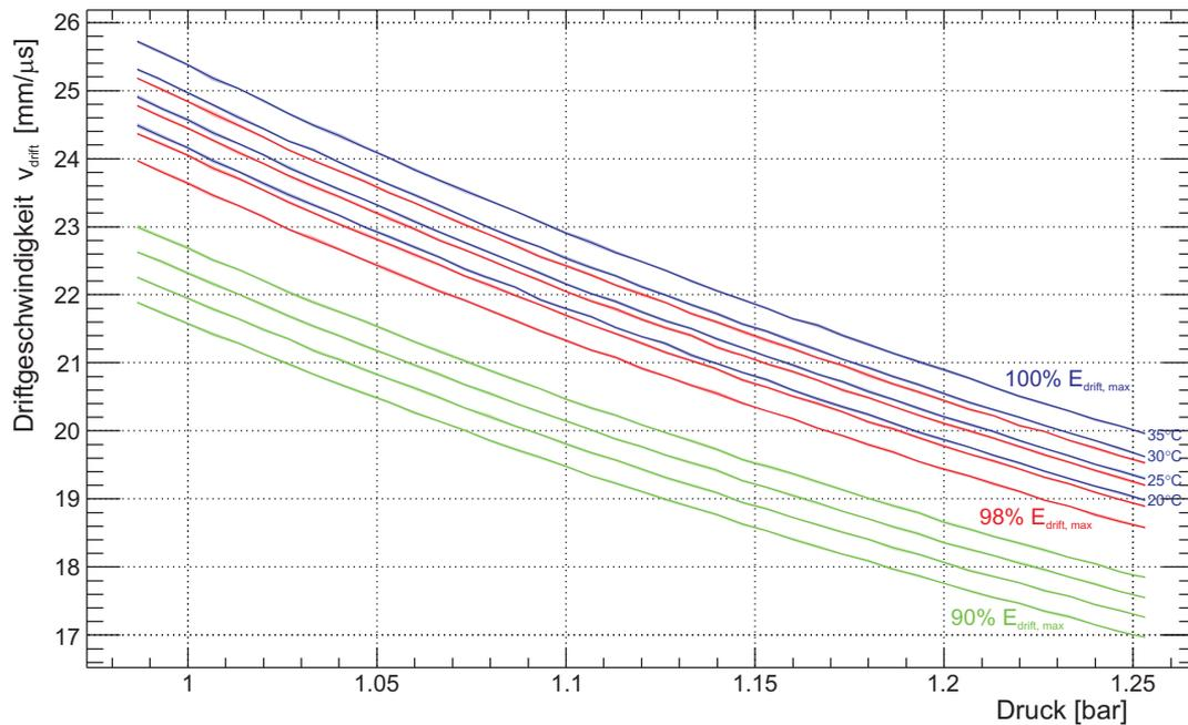
**Abbildung 3.11:** Abhängigkeit der Elektronendriftgeschwindigkeit in  $\text{NeCO}_2$  (90:10) vom Druck bei verschiedenen Driftfeldern und Temperaturen.
