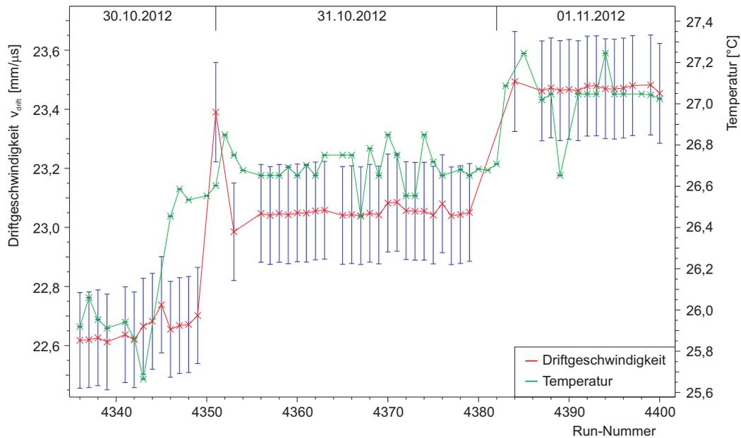
**Abbildung 7.10:** Verlauf der rekonstruierten Driftgeschwindigkeit (rot) und der gemessenen Temperatur (grün) für Messungen an drei aufeinander folgenden Tagen Ende Oktober 2012. Die Messdauer an den einzelnen Tagen betrug jeweils ca. drei Stunden.
