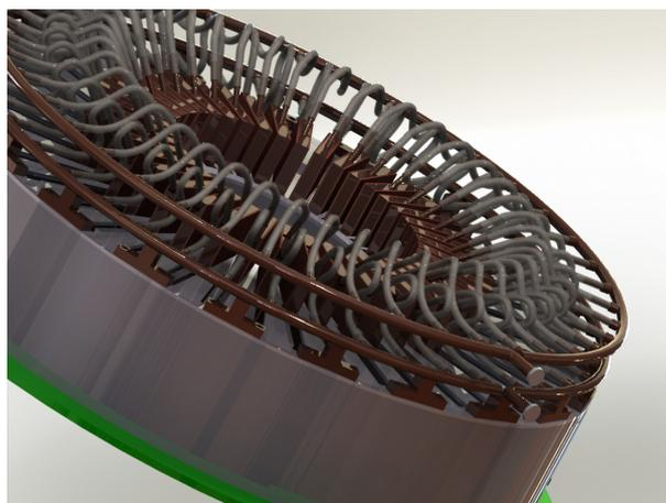
**Abbildung 4.6:** Zeichnung des vollständigen Kühlrings (braun) für die Front-End-Karten [70].
