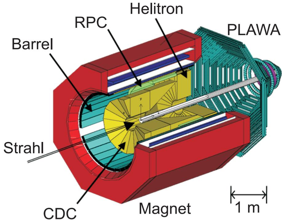
**Abbildung 2.19:** FOPI-Experiment mit Central Drift Chamber (CDC), Vorwärtsdriftkammer (Helitron), Szintillationsdetektoren (Barrel), RPC-Flugzeit-Detektor und Szintillator-Flugzeitwand (PLAWA). Die GEM-TPC befindet sich im Inneren der CDC [90].
