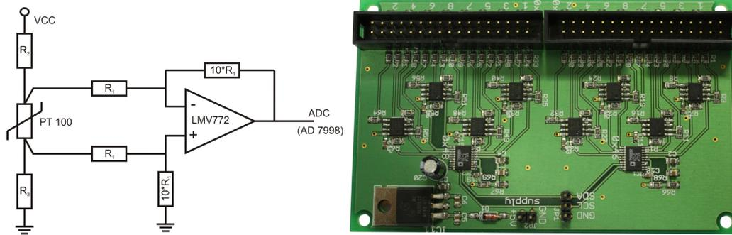
**Abbildung 4.3:** Auslese der Pt100-Sensoren: Die über einem Pt100 abfallende Spannung wird verstärkt und mit einem ADC in ein digitales Signal umgewandelt. 16 dieser Auslesekanäle (links) sind auf der fertig bestückten Platine (rechts) untergebracht.
