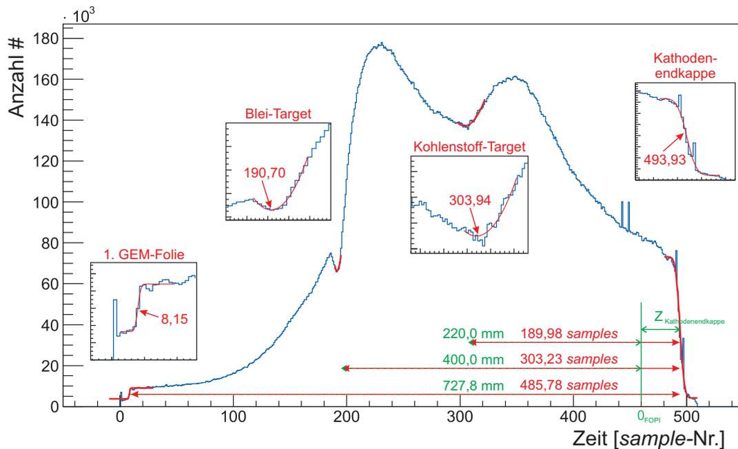
**Abbildung 7.5:** Zeitspektrum für Run 3062 mit angepassten Stufenfunktionen zur Bestimmung der Position der ersten GEM-Folie und der Kathodenendkappe sowie angepassten Parabeln für die Position des Blei- und des Kohlenstofftargets. Die Daten wurden mit der GEM-TPC mit einem  $\pi^-$ -Strahl bei einem Driftfeld von 302,4 V/cm und ArCO<sub>2</sub> (90:10) als Driftgas aufgenommen.
