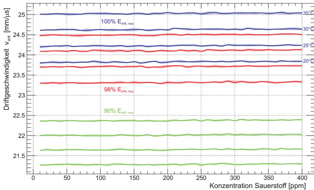
**Abbildung 3.15:** Abhängigkeit der Elektronendriftgeschwindigkeit in NeCO<sub>2</sub> von der Sauerstoffkonzentration im Driftgas bei verschiedenen Driftfeldern und Temperaturen.
