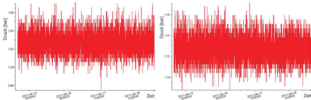
**Abbildung 6.3:** Gemessener Druck am Gaseinlass (links) und am Gasauslass (rechts) der GEM-TPC im Juni 2011.
