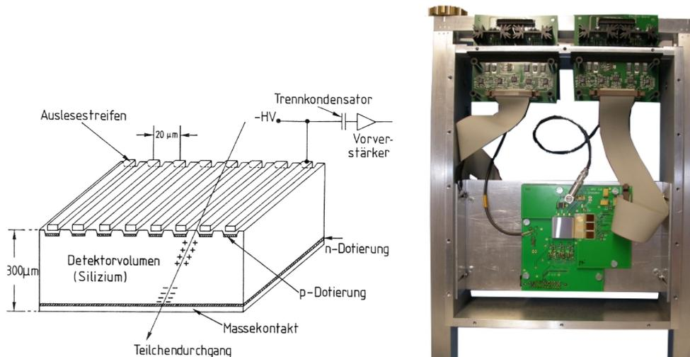
**Abbildung 2.9:** Schematischer Aufbau eines Siliziumstreifendetektors (links, [82]) und Foto eines der verwendeten Detektoren (graues Quadrat in der Mitte) mit angeschlossener Ausleseelektronik (rechts).
