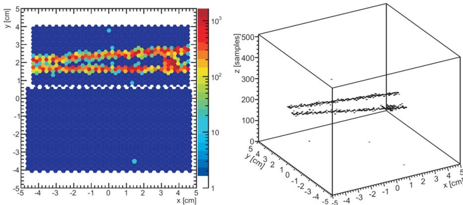
**Abbildung 2.13:** Projektion auf die Ausleseebene (links) und dreidimensionale Rekonstruktion (rechts) eines Ereignisses in der Test-TPC, hervorgerufen durch einen 160 GeV-Myonstrahl am COMPASS-Experiment.
