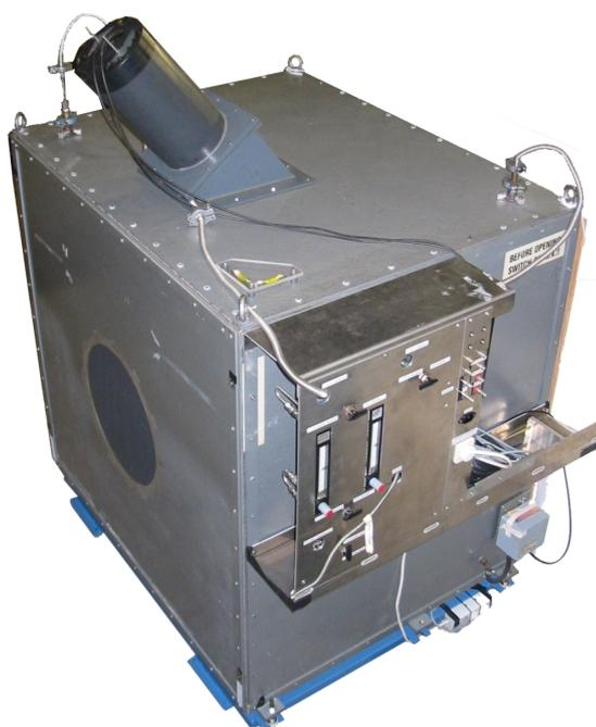
Abbildung 1.17: Gas-Čerenkov-Detektor.
