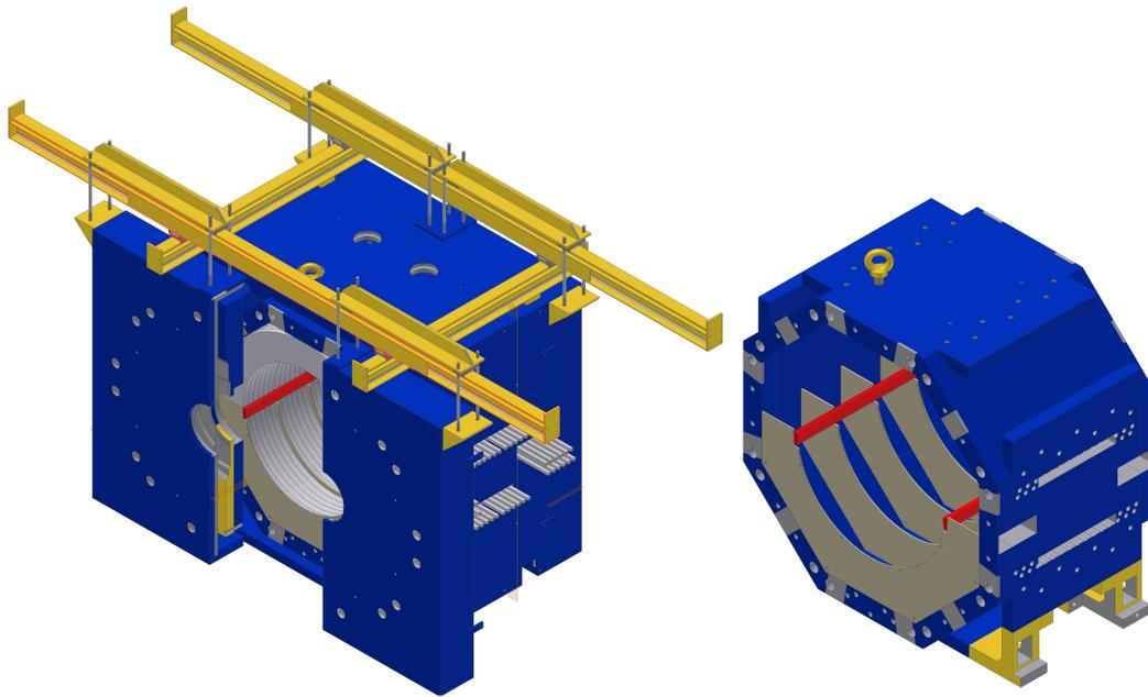
**Abbildung 2.25:** Crystal-Barrel-Rückführjoch des ASTERIX-Experiments mit der alten Aluminiumspule (links). Im inneren Teil (rechts) sind die Schienen als Halterung für den Crystal-Barrel-Detektor und die Löcher der Zuführung für die alten Spulen zu erkennen [34].
