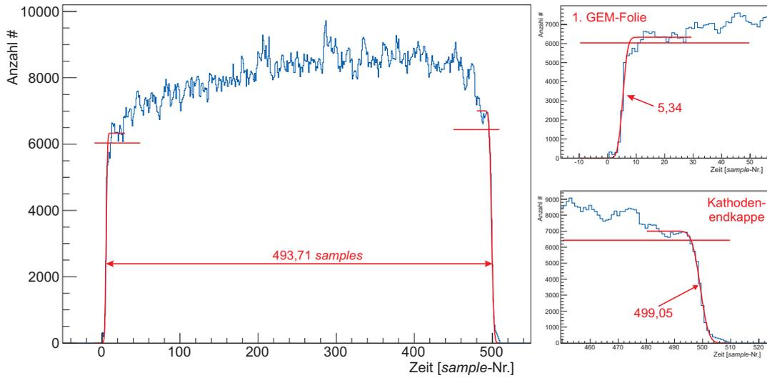
**Abbildung 7.4:** Gesamtes Zeitspektrum für Run 3706 (links) mit angepassten Stufenfunktionen zur Bestimmung der Position der ersten GEM-Folie (rechts oben) und der Kathodenendkappe (rechts unten). Die Daten wurden mit der GEM-TPC mit kosmischer Strahlung bei einem Driftfeld von  $309,6 \text{ V/cm}$  und  $\text{ArCO}_2$  (90:10) als Driftgas aufgenommen.
