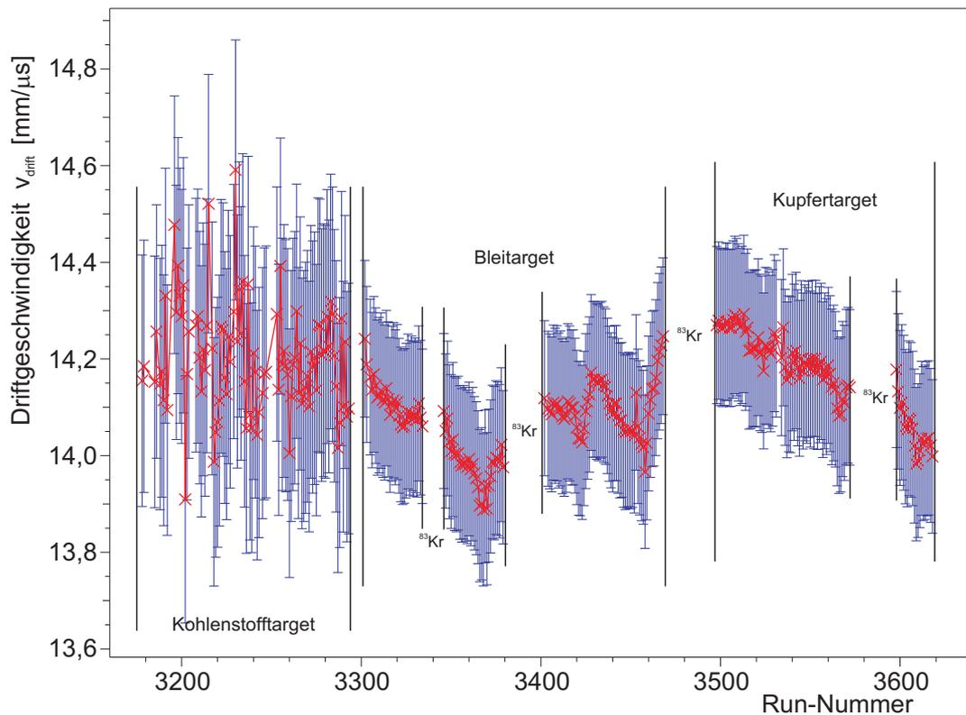
**Abbildung 7.8:** Für die  $\pi^-$ -Strahlzeit im Juni 2011 rekonstruierte Driftgeschwindigkeiten, aufgetragen gegen die Nummer des zugehörigen Runs. Die verhältnismäßig großen Fehler ergeben sich vor allem aus dem Fehler der Driftstrecke  $l_{\text{Pb-Cu-C-Target}}$ .
