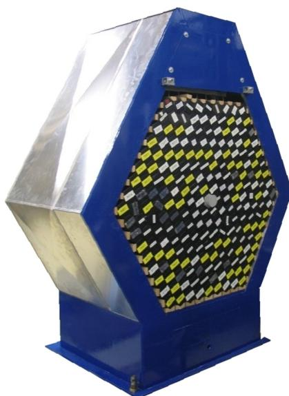
**Abbildung 1.15:** Der MiniTAPS-Detektor mit seinen 216 BaF<sub>2</sub>-Kristallen.
