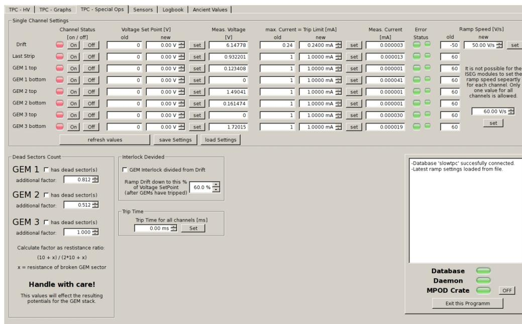
**Abbildung C.10:** Auf der Registerkarte 'TPC - Special Ops' können spezielle Einstellungen für die TPC-Hochspannungen vorgenommen werden.
