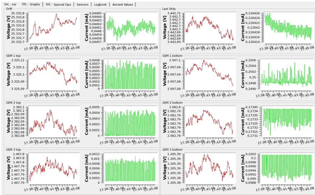
**Abbildung C.9:** Die Registerkarte ‘TPC - Graphs’ zeigt den Verlauf der acht gemessenen Spannungen (rot) und Ströme (grün) an der GEM-TPC für die letzten 15 Minuten.
