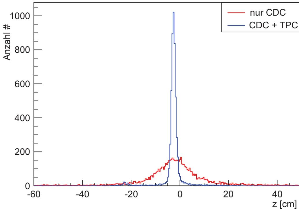
**Abbildung 7.15:** Verteilung der  $z$ -Koordinate rekonstruierter Vertices aus der Wechselwirkung eines  $\pi$ -Strahls mit einem 10 mm dicken Kohlenstofftarget unter Verwendung der CDC-Daten alleine (rot) und in Verbindung mit den Daten der GEM-TPC (blau) [127].
