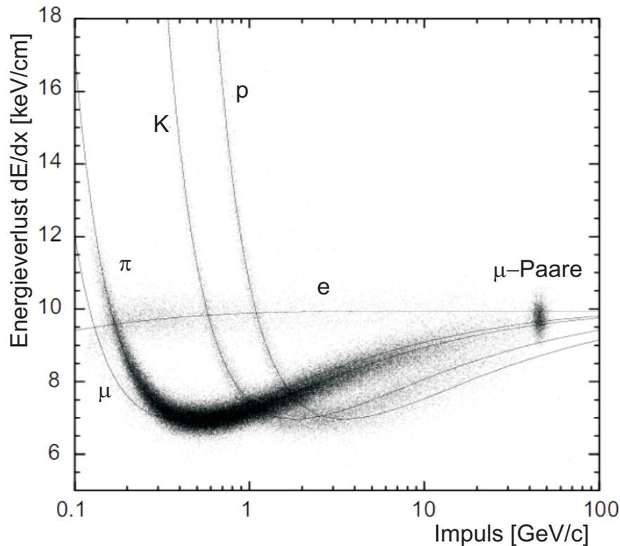
**Abbildung 2.6:** Spezifischer Energieverlust  $dE/dx$  geladener Teilchen in Abhängigkeit ihres Impulses, bestimmt mit der OPAL *jet chamber* [77].
