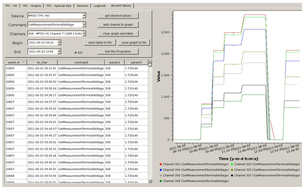
**Abbildung C.13:** Registerkarte ‘Ancient Values’ zum Anzeigen der in der Datenbank gespeicherten Werte.
