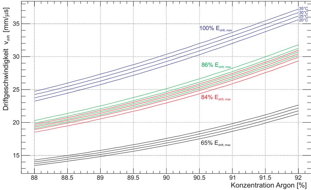
**Abbildung 3.12:** Abhängigkeit der Elektronendriftgeschwindigkeit in  $ArCO_2$  (90:10) von der Argonkonzentration bei verschiedenen Driftfeldern und Temperaturen.
