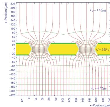
Abbildung 2.4: Verlauf des elektrischen Feldes an einer GEM-Folie [68].
