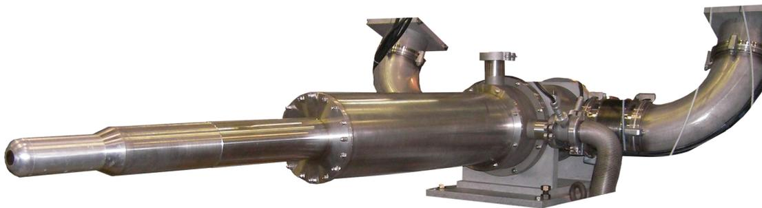
**Abbildung 1.11:** Kryostat und Halterung des polarisierten Targets.
