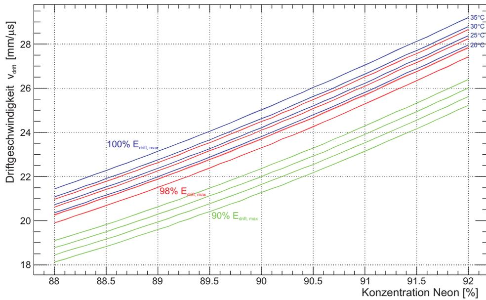
**Abbildung 3.13:** Abhängigkeit der Elektronendriftgeschwindigkeit in  $NeCO_2$  (90:10) von der Neonkonzentration bei verschiedenen Driftfeldern und Temperaturen.
