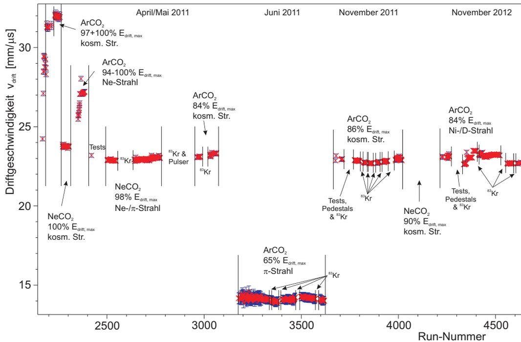
**Abbildung 7.7:** Aus den Daten der GEM-TPC rekonstruierte Driftgeschwindigkeiten, aufgetragen gegen die Nummer des zugehörigen Runs. Die Anzahl an Ereignissen in den Runs und die jeweilige Startzeit sind in Anhang E aufgelistet.
