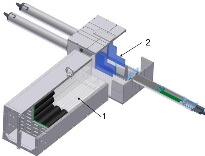
**Abbildung 1.18:** Zeichnung des Gamma-Intensitätsmonitors (1) und des Flussmonitors (2) [34].
