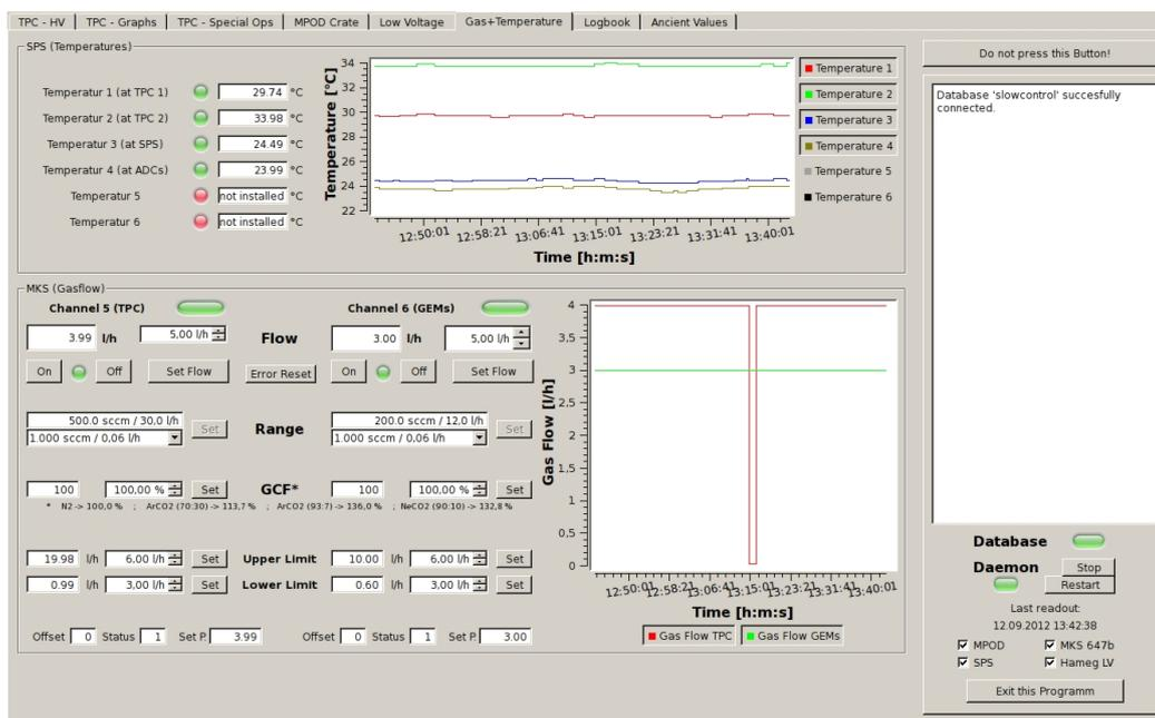
**Abbildung C.18:** Der obere Abschnitt auf der Registerkarte ‘Gas+Temperature’ zeigt die Temperaturen an der TestBench. Im unteren Abschnitt können die Einstellungen des Gassystems vorgenommen und die ausgelesenen Werte betrachtet werden.
