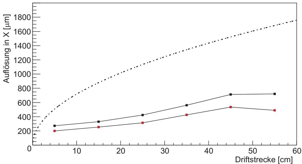
**Abbildung 7.13:** Aus den Residuen bestimmtes Auflösungsvermögen der  $x$ - und  $y$ -Koordinate in der GEM-TPC in Abhängigkeit von der Driftstrecke [127]. Die roten Punkte geben dabei das Sigma der schmalen Gauß-Verteilung, die schwarzen Punkte den gewichteten Mittelwert der beiden Gauß-Verteilungen und die gestrichelte Linie die simulierte, transversale Diffusion für einzelne Elektronen an.
