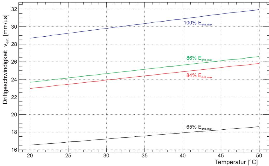
**Abbildung 3.8:** Abhängigkeit der Elektronendriftgeschwindigkeit in ArCO<sub>2</sub> (90:10) von der Temperatur bei verschiedenen Driftfeldern.
