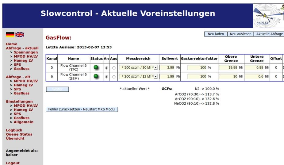
Abbildung C.4: Webseite zur Änderung der Parameter am Gassystem der TestBench.
