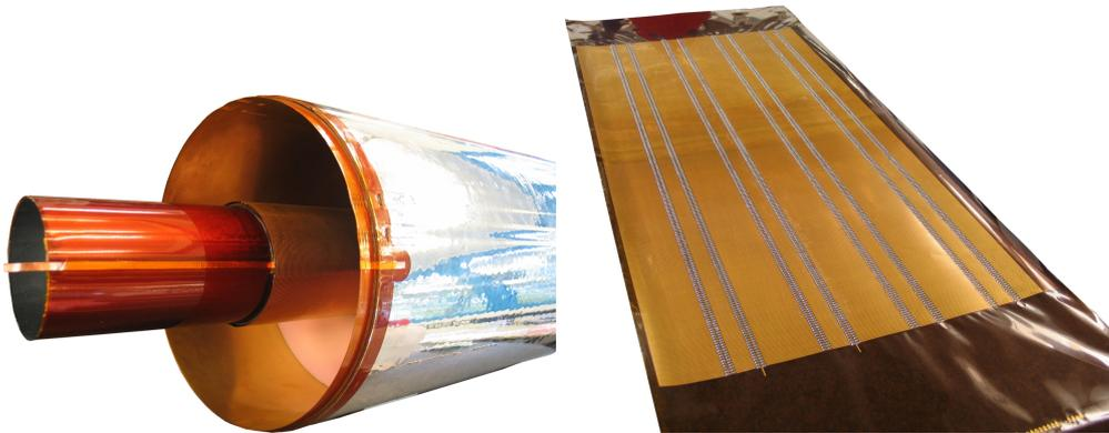
**Abbildung 2.14:** Fertiger Feldkäfig (links). Am inneren Zylinder sind die Kupferringe und auf der entrollten Folie für den Feldkäfig (rechts) zusätzlich die SMD-Widerstände zu erkennen, die das homogene elektrische Feld erzeugen.
