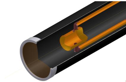
**Abbildung 1.12:** Zeichnung der Kapton-Zelle des Flüssig-Wasserstoff-Targets [34].
