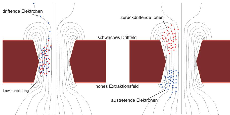
**Abbildung 2.5:** Verstärkung an einer GEM-Folie: Elektronen werden in die Löcher geleitet, wo es durch die hohen elektrischen Felder zu einer lawinenartigen Bildung von Elektron-Ion-Paaren kommt (links). Durch die asymmetrische Feldverteilung und die geringere Beweglichkeit der Ionen werden diese auf der Vorderseite der GEM-Folie aufgefangen, während ein Großteil der Elektronen an der Rückseite der GEM-Folie austritt (rechts). [70]
